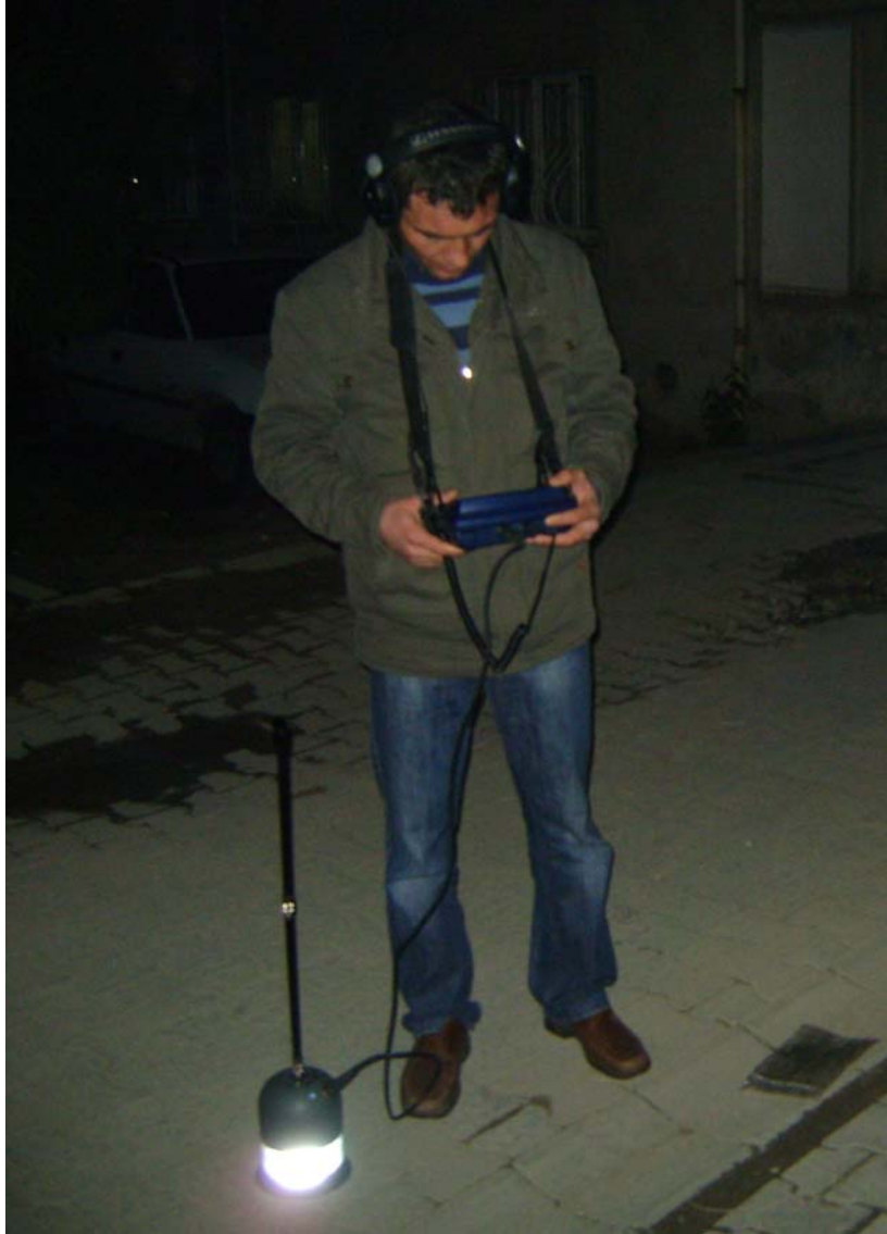
Şekil 3.1. Yer mikrofonu ile yapılan çalışma örneği
