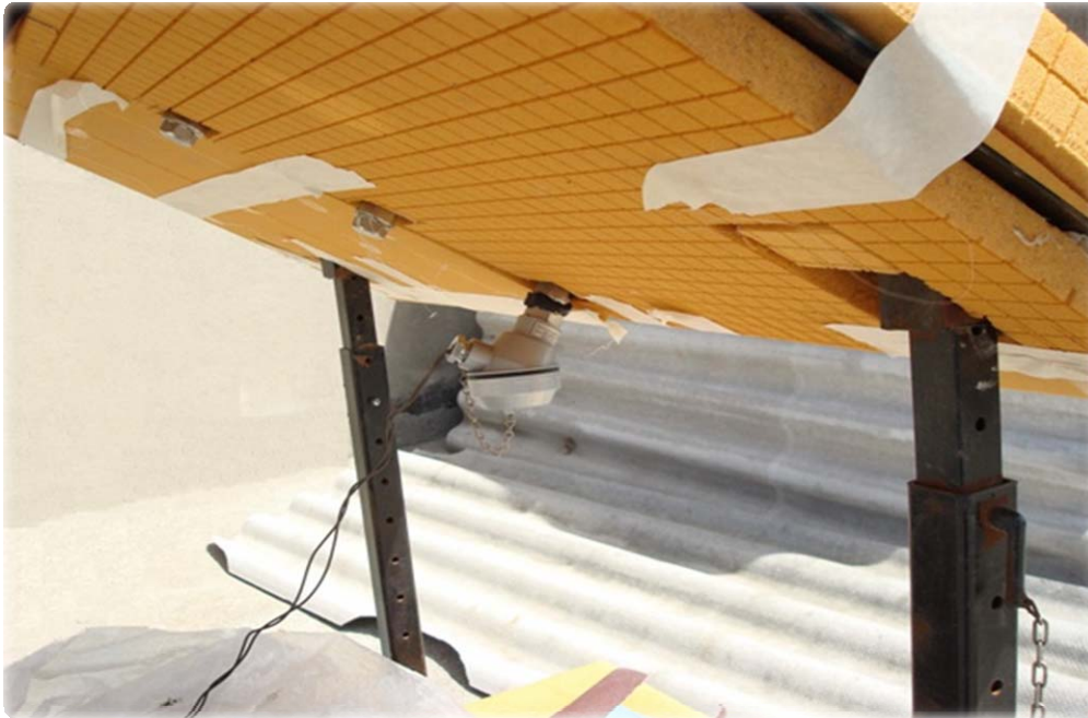
Şekil 4.3 Buharlaştırmacı Tarafı Altan Görünüşü
