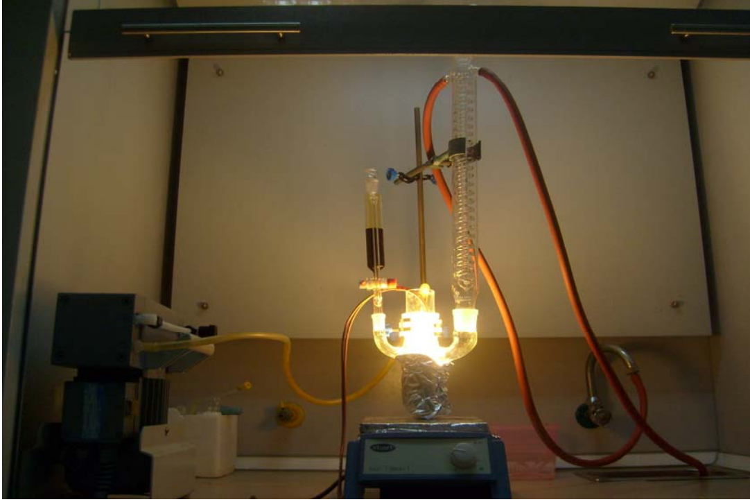
Şekil 3.2. Fotobrominasyon düzeneğinin fotobromlamaya hazır hale getirilmesi.
