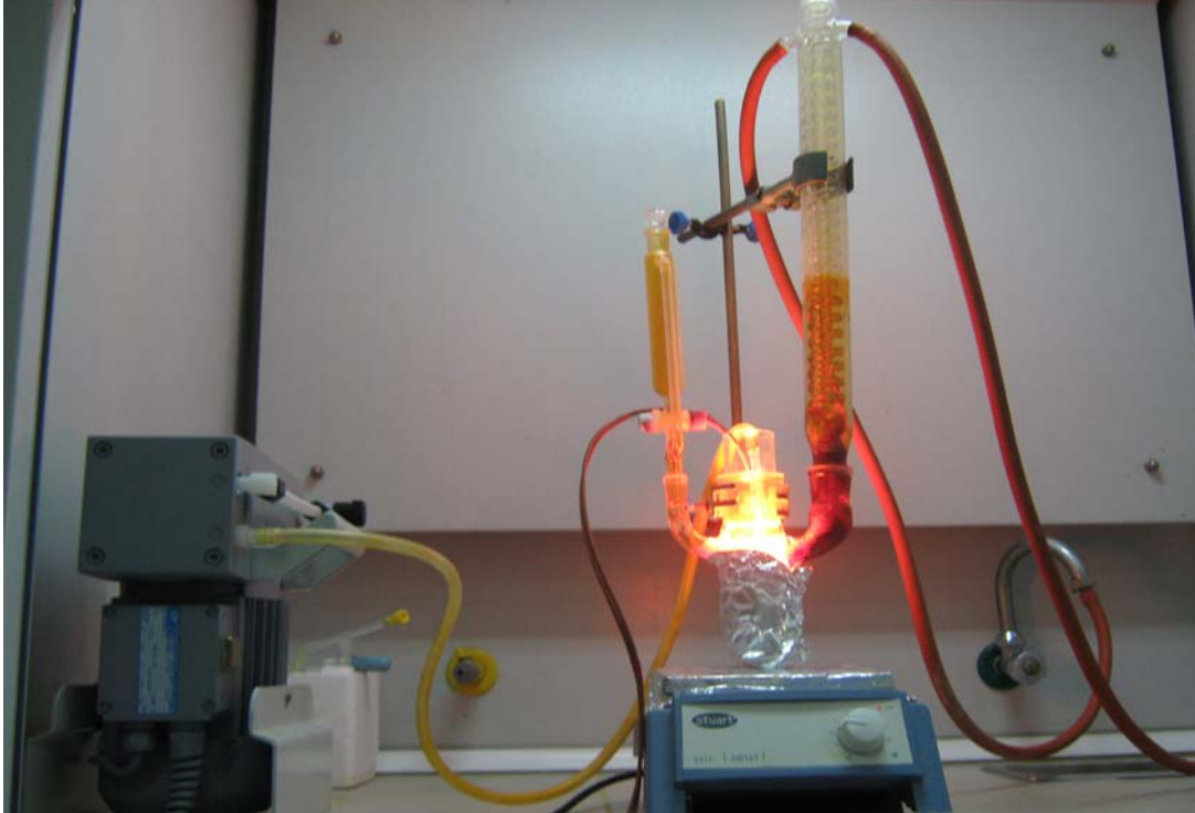
Şekil 3.3. Fotobrominasyon düzeneğinde reflüks sıcaklığında brominasyon
