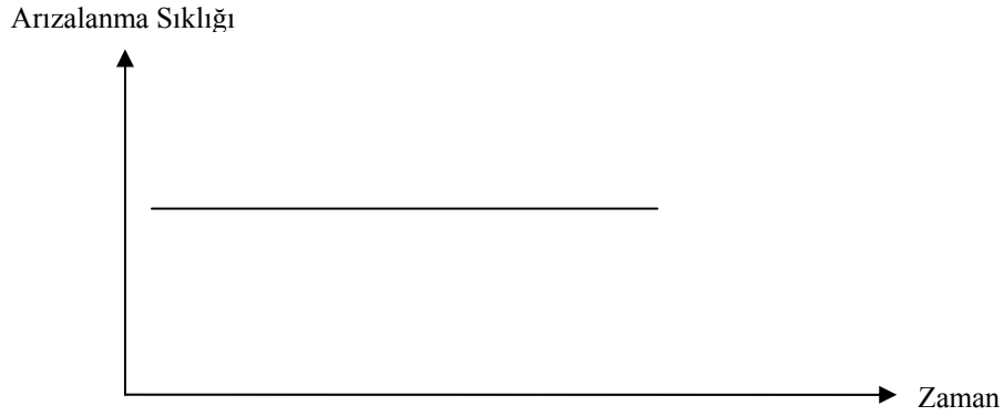
Şekil 2.4. Elektrik-Elektronik sistemlerin arıza karakteri
