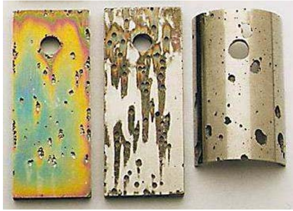
Şekil 2.1. Cl iyonlarının bulunduğu ortamda görülen pitting ( oyuk) korozyonu[17].
