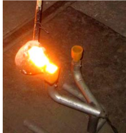
Şekil 3.2. ATAS cihazına termokapıl'ın yerleştirilmesi ve numunenin dökümü
