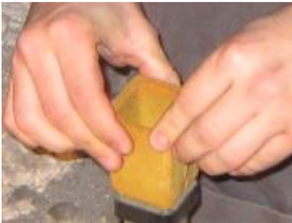
Şekil 3.2. ATAS cihazına termokapıl'ın yerleştirilmesi ve numunenin dökümü
