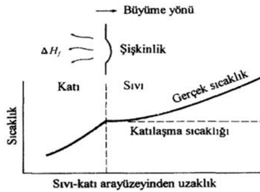
Şekil 2.8. Düzlemsel büyümenin oluşumu [8]
