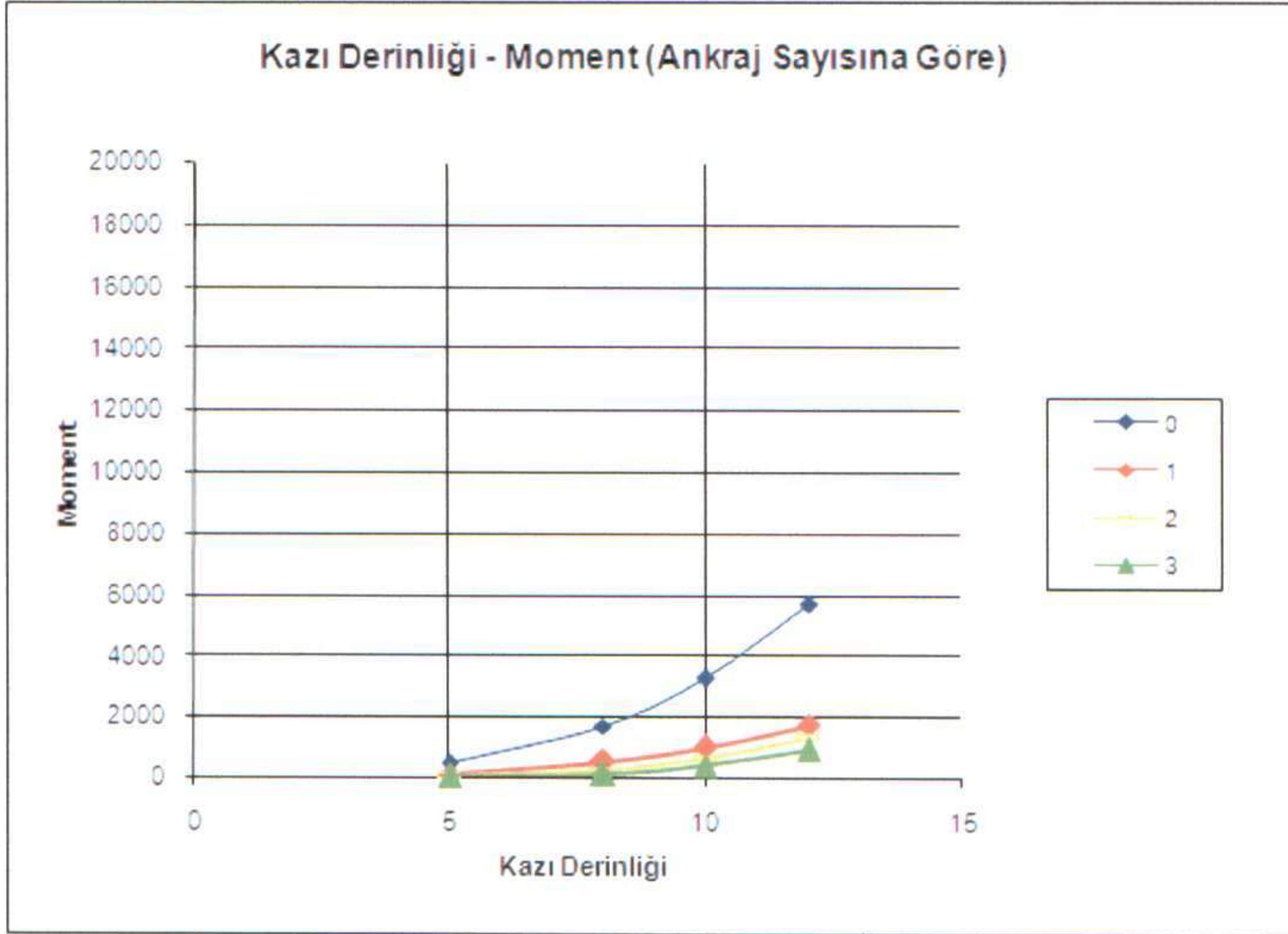
Şekil Ek B55 – Kazı Derinliği – Moment Ankraj Sayısı ve Case A'ya Göre (3.Tip)
