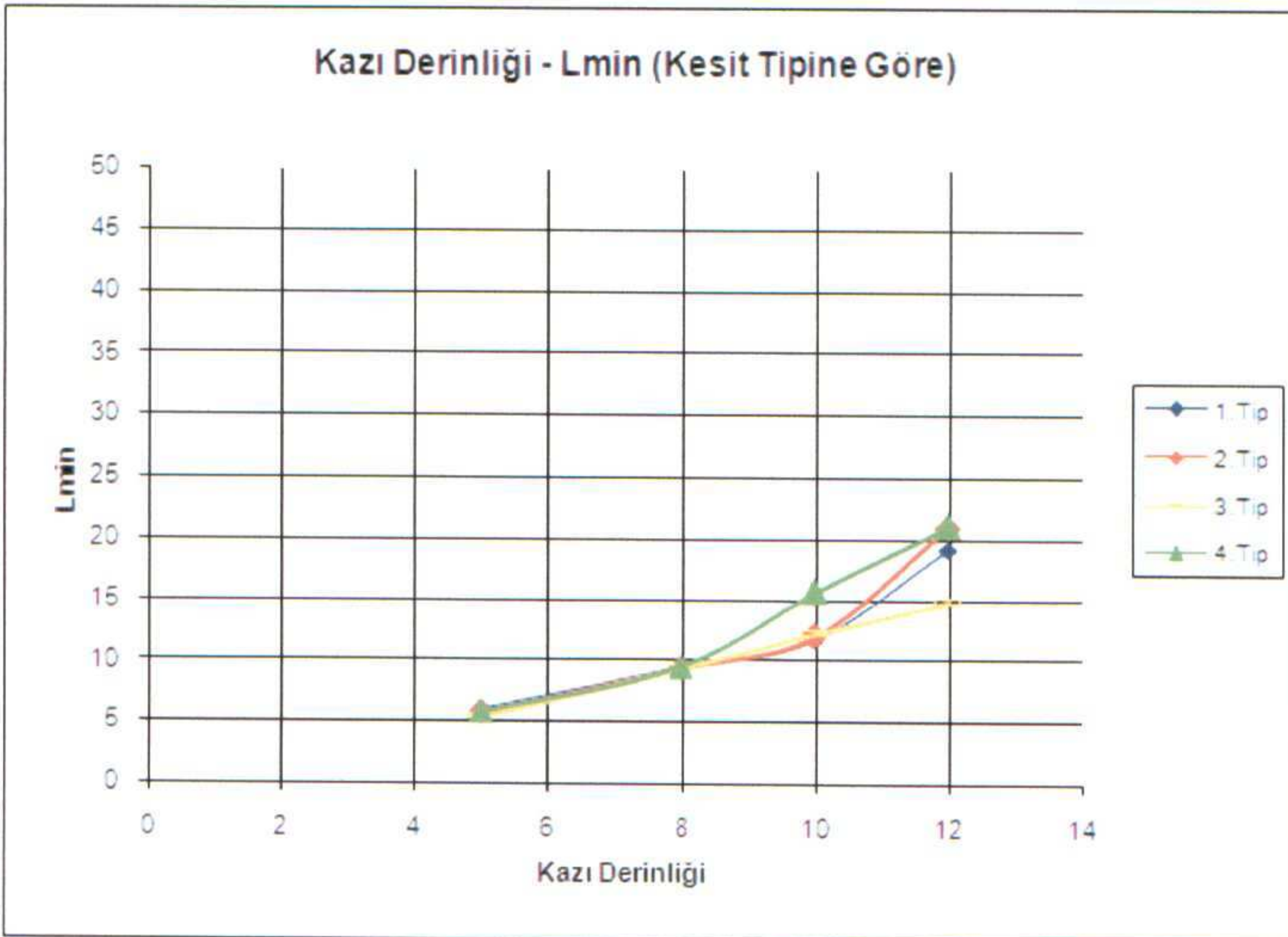
Şekil Ek B30 – Kazı Derinliği – L_{min} Grafiği (Üç ankraj ve Case B)
