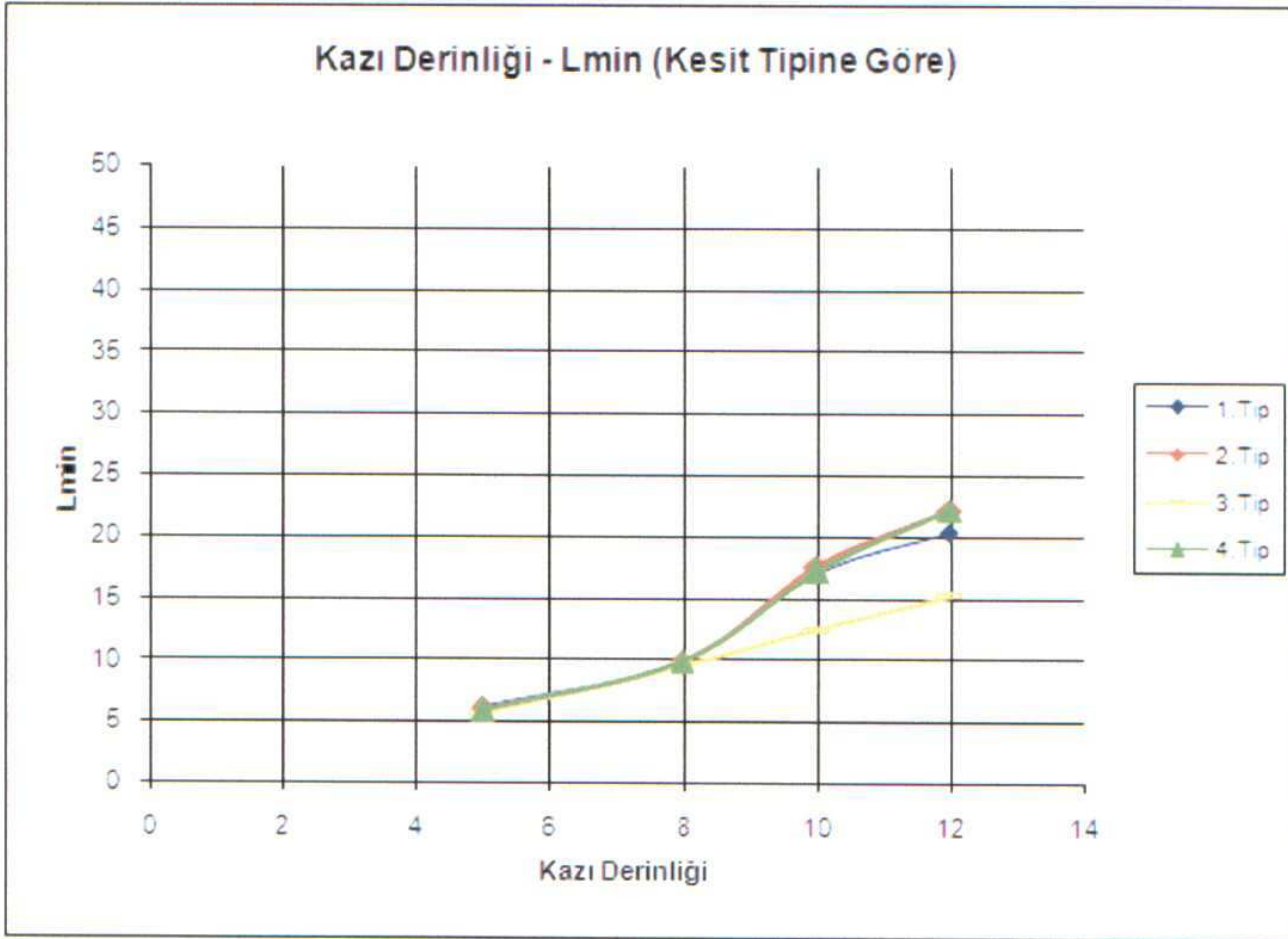
Şekil Ek B29 – Kazı Derinliği – L_{min} Grafiği (Üç ankraj ve Case A)
