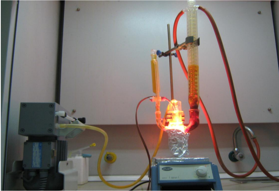
Şekil 3.1. Fotobrominasyon düzeneğinde reflüks sıcaklığında brominasyon
