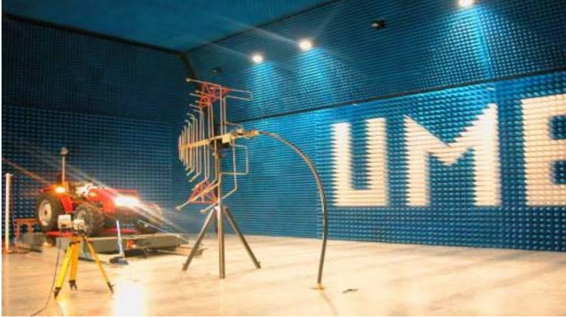
Şekil 5.11. Bir traktöre uygulanan ışınım karşı bağışıklık testi (TÜBİTAK-UME'den alınmıştır)
