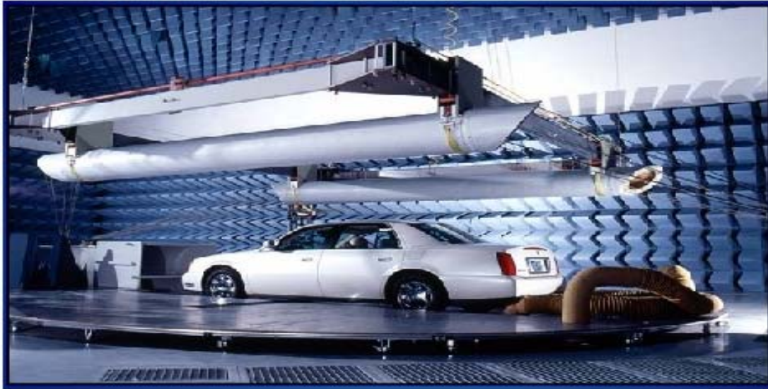
Şekil 4.2. Bir otomobile yapılan EMC testi (ETS-Lindgren'den alınmıştır.)
