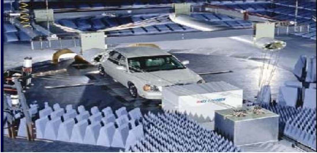
Şekil 4.1. Bir otomobile yapılan ışıman emisyon EMC testi (ETS-Lindgren'den alınmıştır.)
