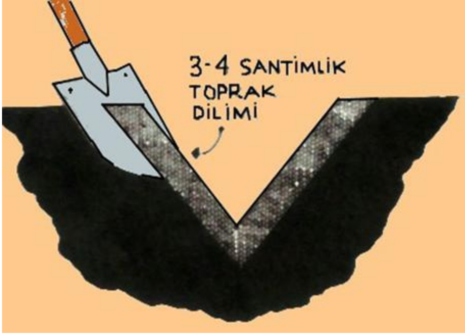
Şekil 3.3. Toprak numunesi alınması
