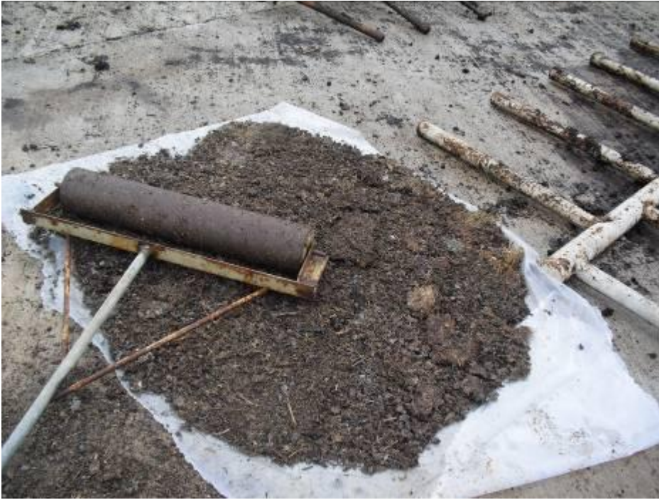
Şekil 6.2. Fındık kabuklarını kırmakta kullanılan el silindiri
