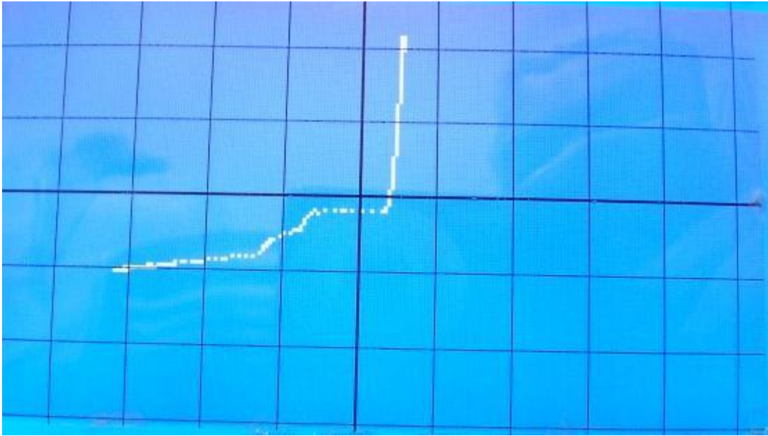
Şekil E. 16. Sağlam 7918 entegresinin 1-2 uçları arasına ait I-V eğrisi(kademe 15V)
