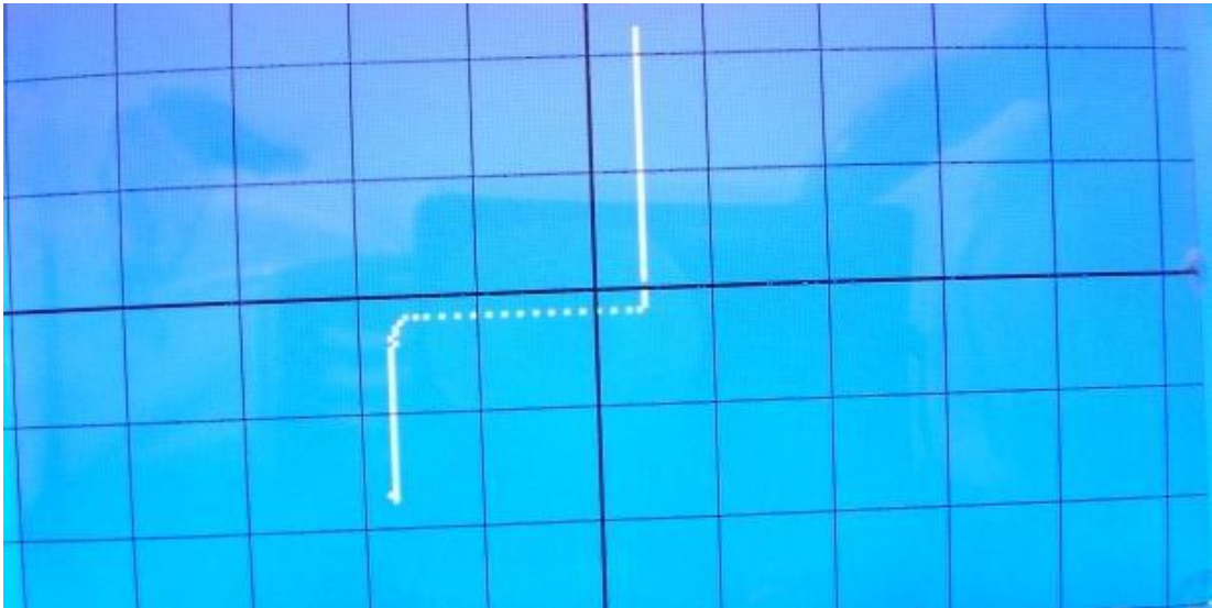
Şekil E. 14. 5.1V'luk zener diyotun 15V kademesindeki I-V eğrisi
