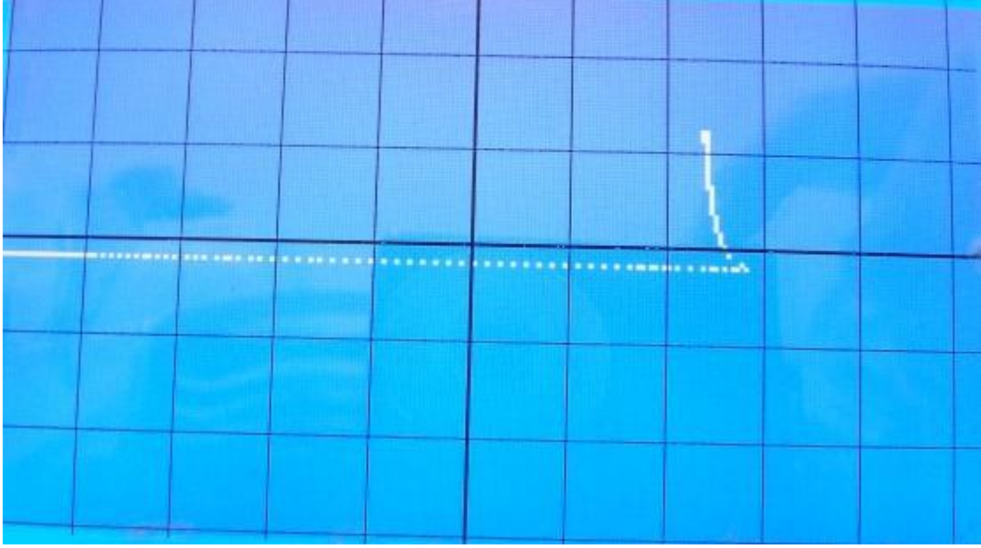
Şekil E. 17. BC546 transistorünün Emiteer-Kollektör bacakları arasına ait I-V eğrisi(kademe 15V)
