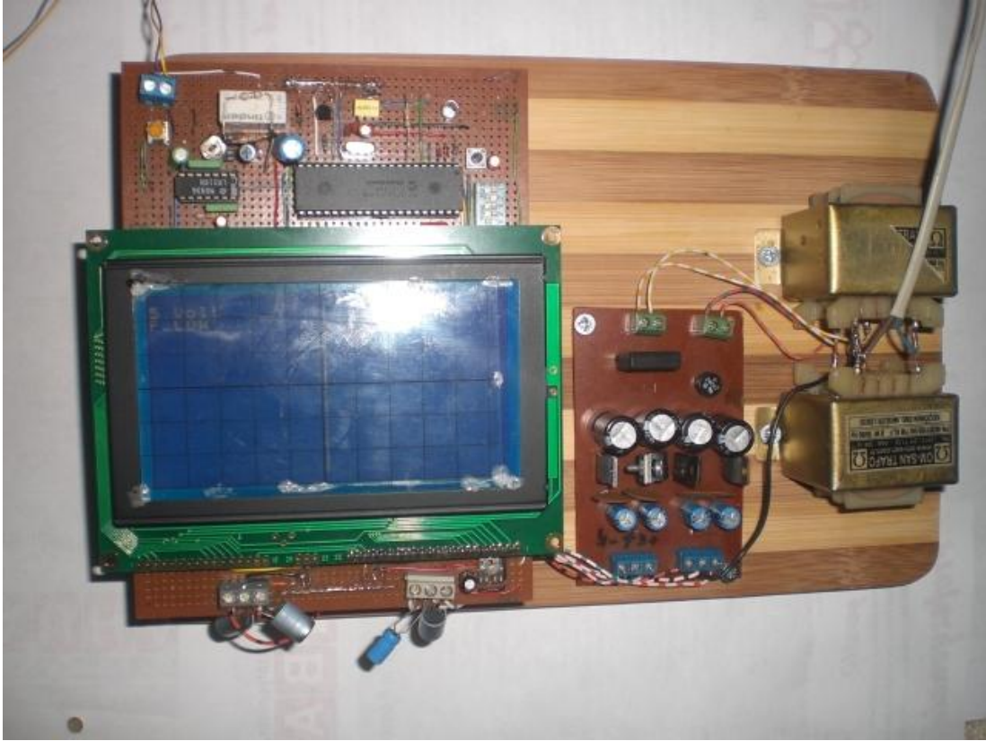
Şekil 5.2. Tasarlanan I-V Eğri çizicinin sayısal kısmı ve güç kaynağı
