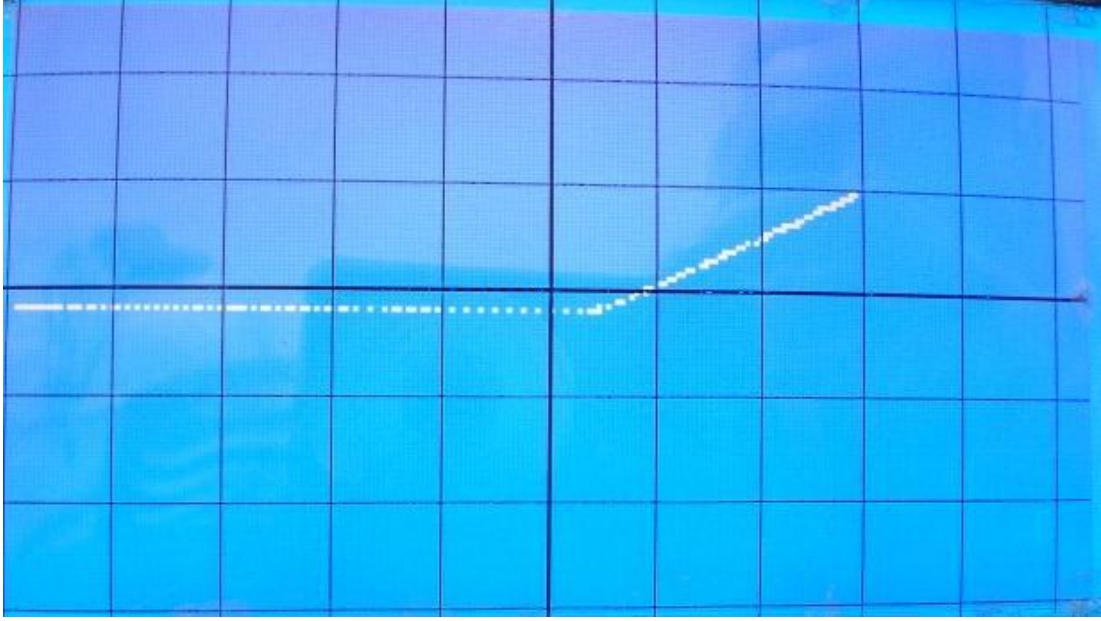
Şekil E. 19. 1Kohm'luk direnç ile 1N4001 diyotunun seri bağlanması ile elde edilen elemana ait I-V eğrisi
