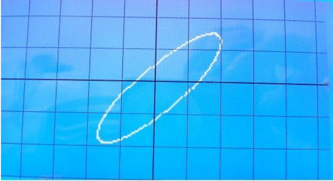
Şekil E. 4. 12V'luk bir röle bobinine ait I-V eğrisi
