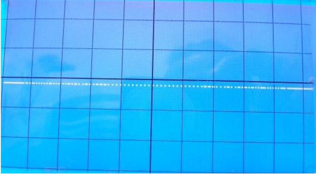
Şekil E. 1. Açık devre elemanına ait I-V eğrisi
