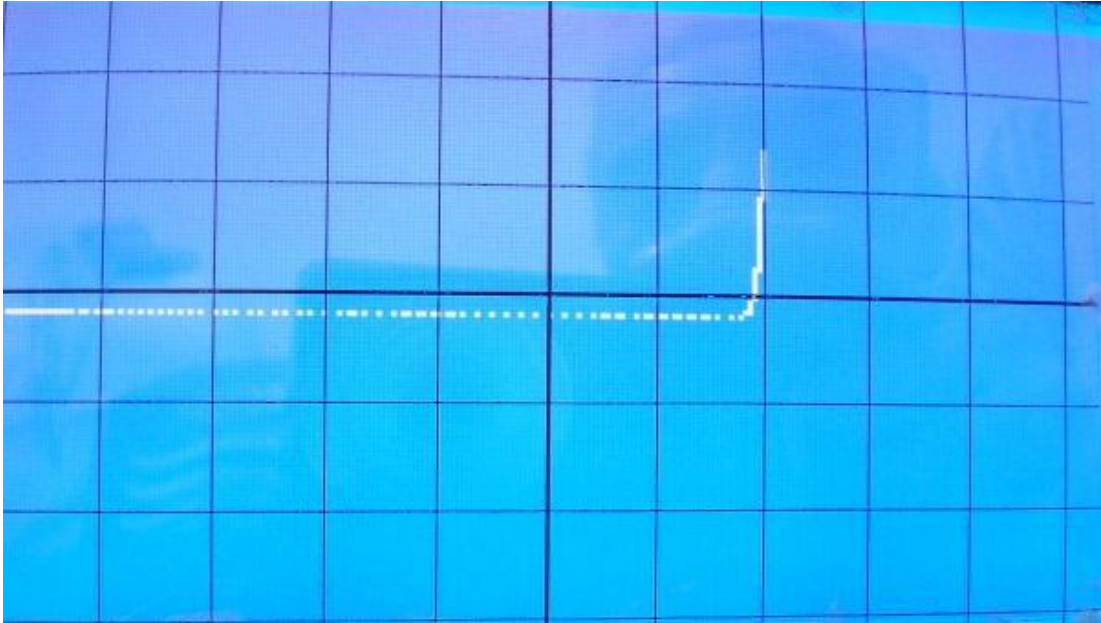
Şekil E. 10. Kırmızı LED'in 5V kademesindeki I-V eğrisi
