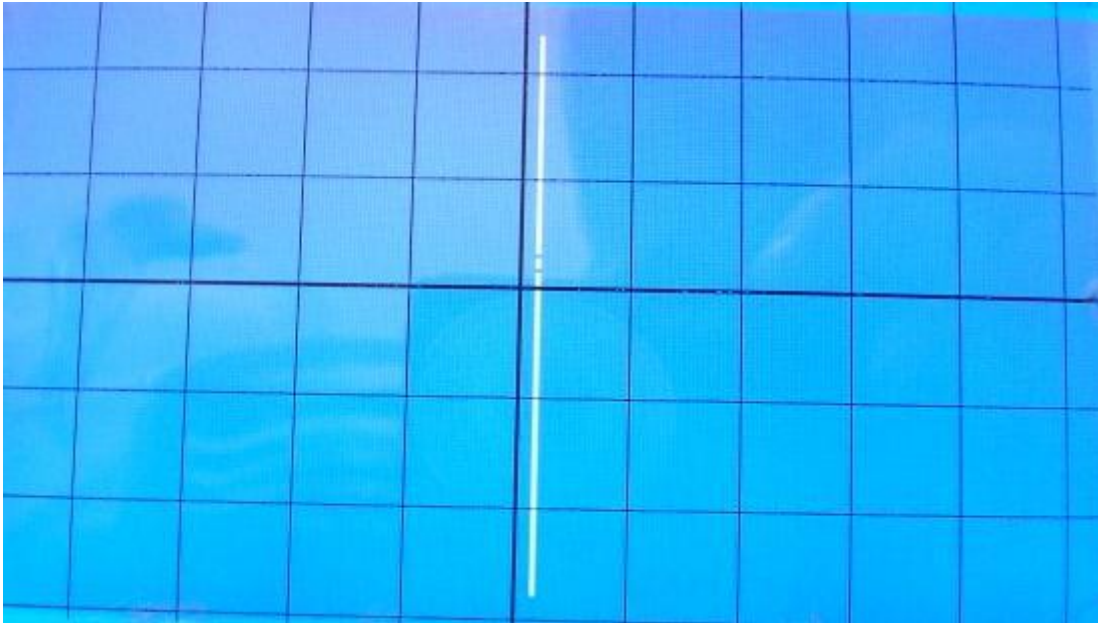
Şekil E. 2. Kısa devre elemanına ait I-V Eğrisi
