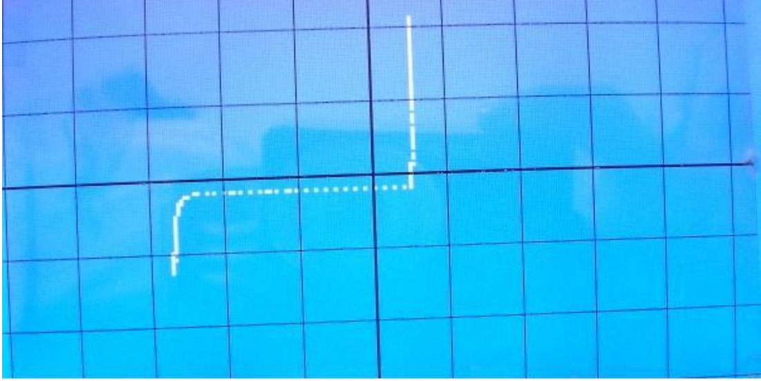
Şekil E. 13 .5.1V'luk zener diyotun 10V kademesindeki I-V eğrisi
