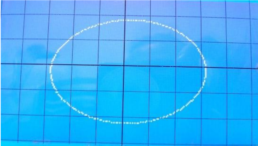
Şekil E. 6. 4,7 uF'lık kondansatörün F_LOW kademesindeki I-V eğrisi
