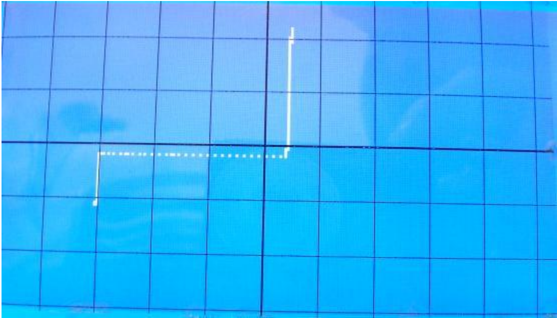
Şekil E. 18. BC546 transistorünün Beyz-Emiteer bacakları arasına ait I-V eğrisi(kademe 15V)
