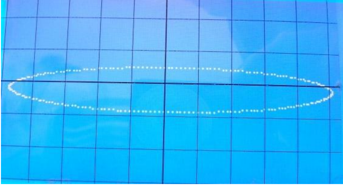
Şekil E. 7. 1\mu\text{F} 'lık kondansatörün F_LOW kademesindeki I-V eğrisi
