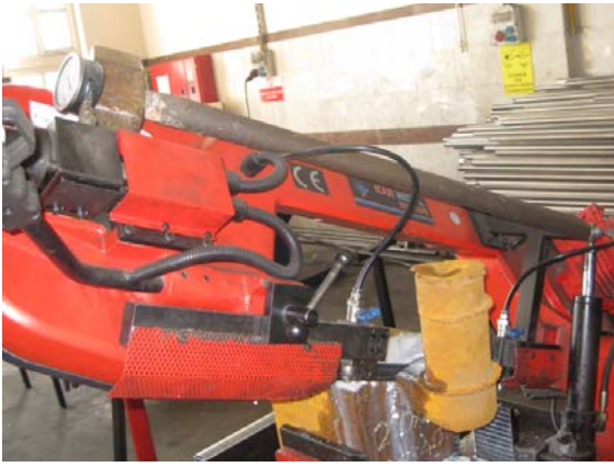
Şekil 3.13.a. ve 3.13.b Numunenin döküm parçadan kesilerek çıkarılması
