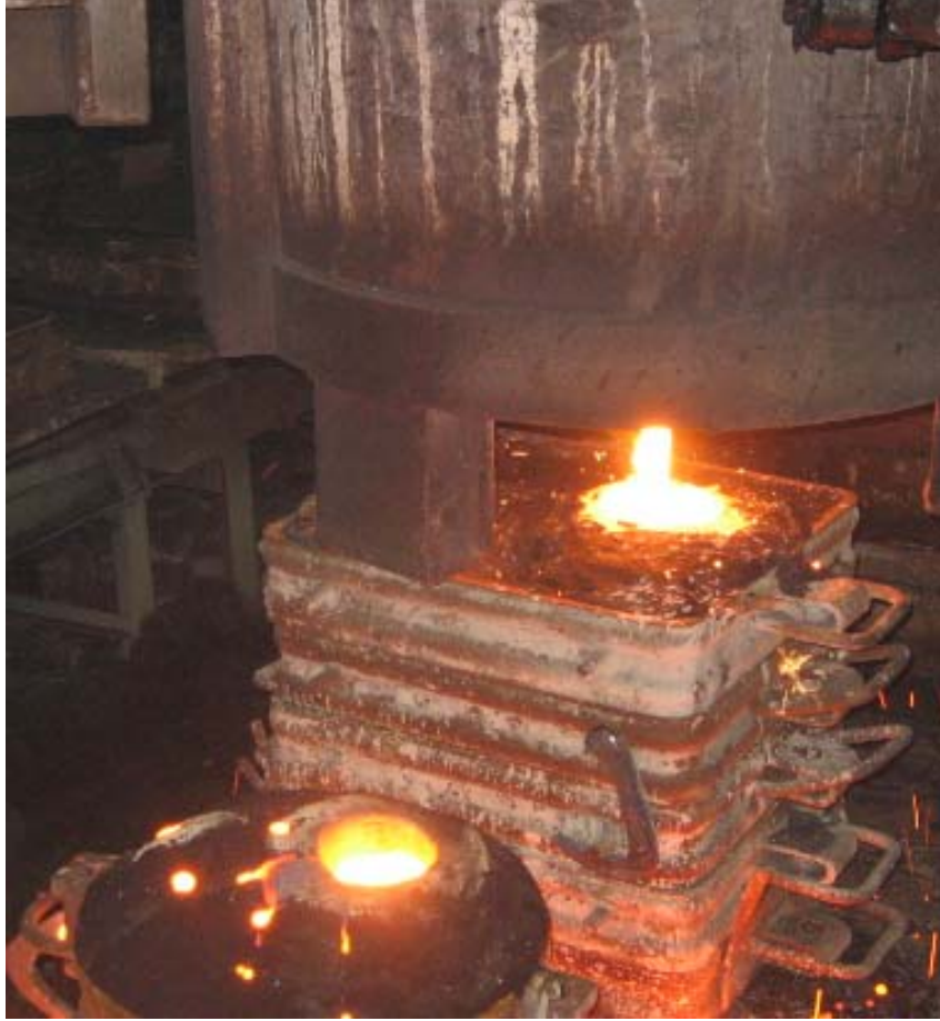
Şekil 3.11. Dökülmüş bir kalıbın görünüşü
