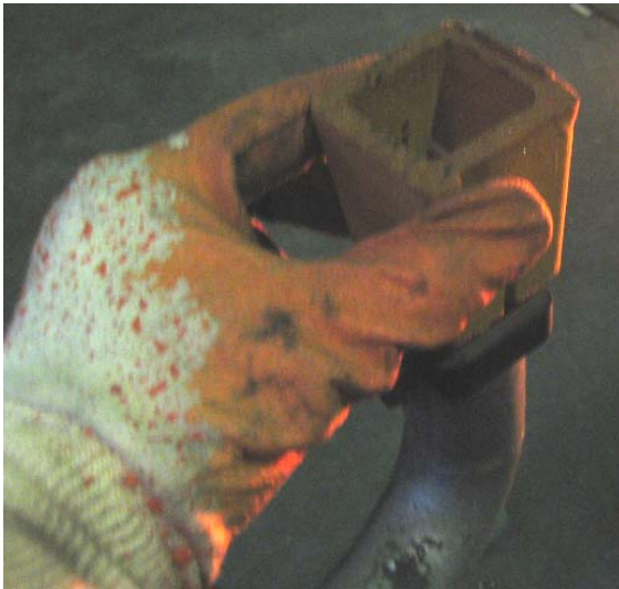
Şekil 3.27.a. Atas cihazına termokapılın yerleştirilmesi
