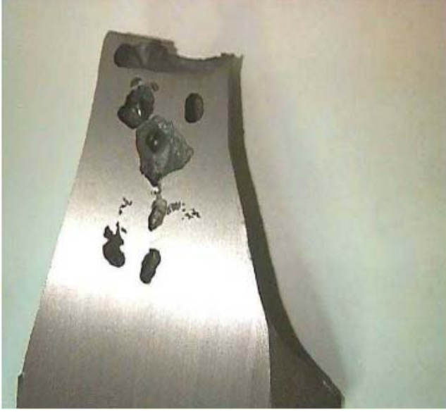
Şekil 2.11.Küresel Grafitli dökme demirin normal katlaşması ile oluşan çekinti[8,10]
