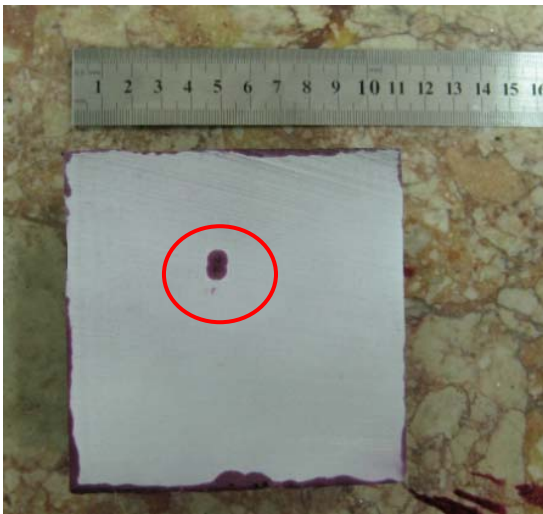
Şekil 4.11. Besleyicisiz dökülen GGG60 100x100x100 numunenin görüntüsü
