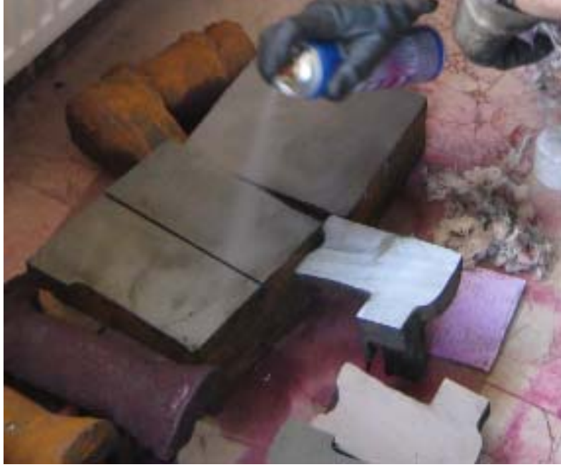
Şekil 3.14. Sıvı penetrant muayenesi öncesi temizlik işlemi
