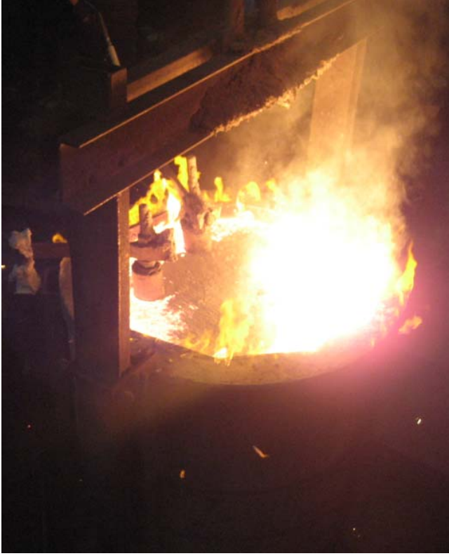
Şekil 3.2. Sıvı metalin aşılması ve argon gazı ile yıkılması
