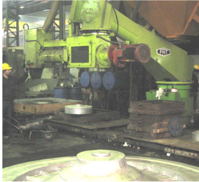
Şekil 3.7. Karıştırma mikserinde kumun hazırlanması
