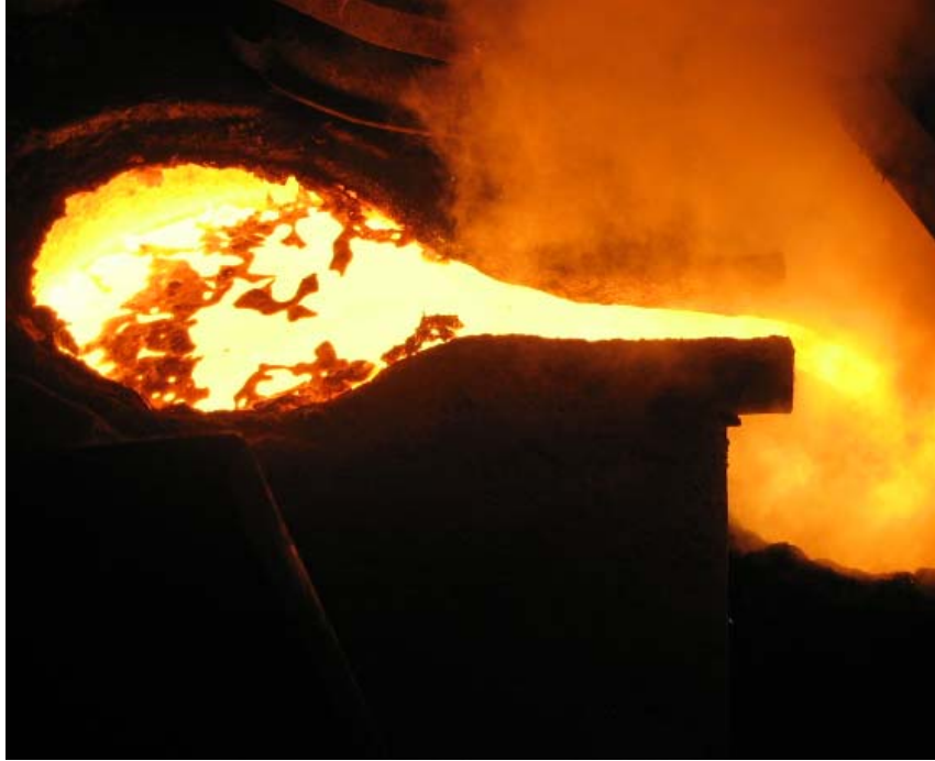
Şekil 3.10. Sıvı metalin potaya aktarımı
