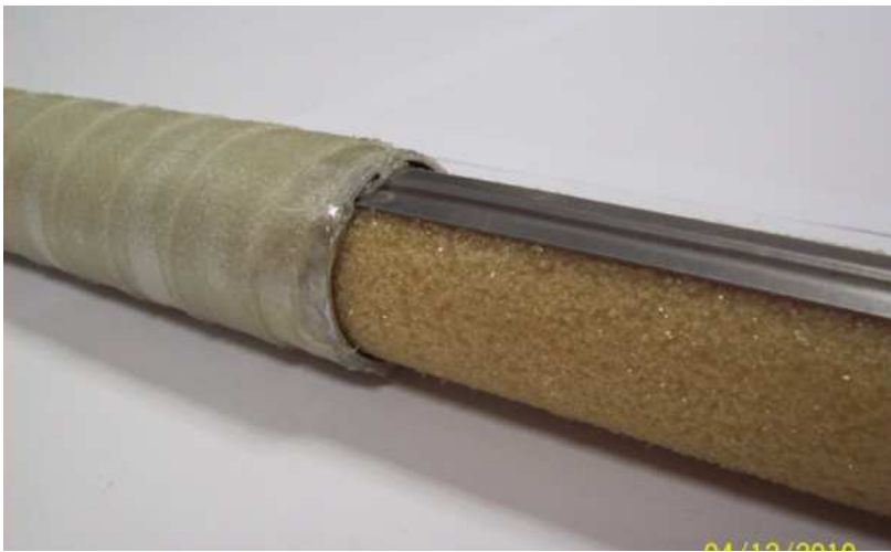
Şekil 2.10. Metal takviye ve PVC köpüğün “ACE3PM” Tipi numunede montajı.
