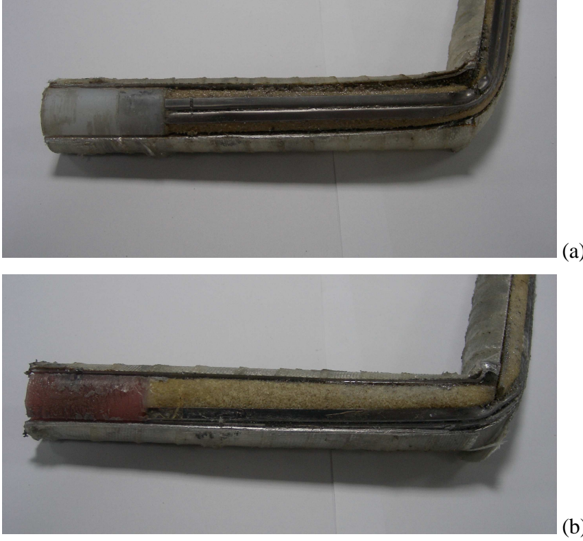
Şekil 3.25 (a) Yapıştırma işlemi uygulanmamış numunede metal takviyenin deney sonrası konumu. (b) Yapıştırma işlemi uygulanmış numunede metal takviyenin deney sonrası konumu.
