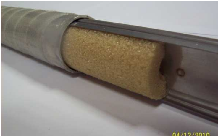
Şekil 2.8. Metal takviye ve PVC köpüğün “ACE1PM” Tipi numunede montajı.
