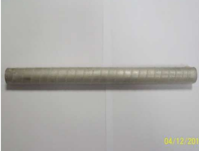
Şekil 2.3. “ACE1” Tipi numunenin fırınlama sonrası görünümü
