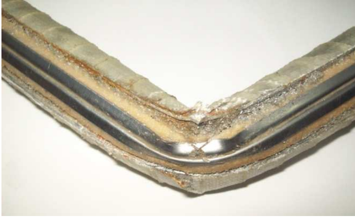
Şekil 3.23. Deney sonrası metal takviyenin konumu
