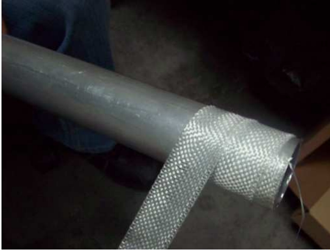
Şekil 2.2. “ACE1” Tipi numuneye cam elyaf bant uygulaması
