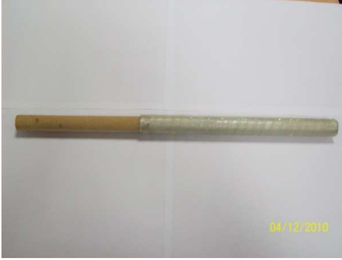
Şekil 2.5. “ACE1P” Tipi numunede profile PVC köpük montaj şekli.
