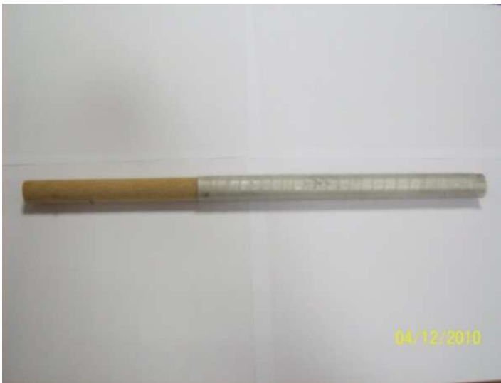
Şekil 2.6. “ACE3P” Tipi numunede profile PVC köpük montaj şekli.
