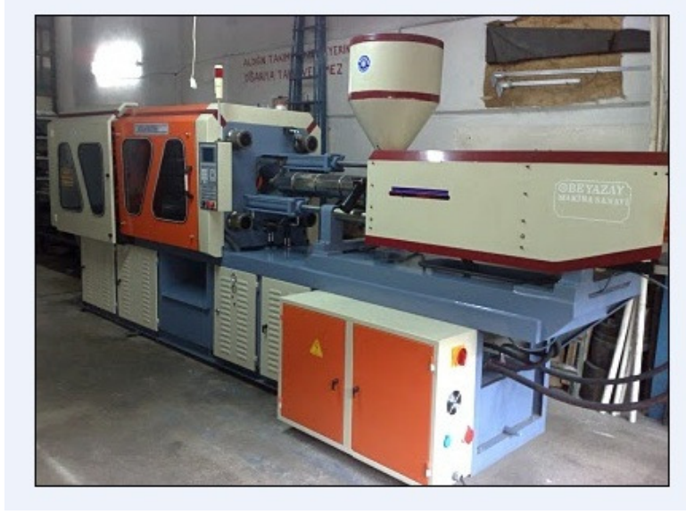
Şekil 6.5. Test numunelerinin yapıldığı Enkel plastik Enjeksiyon makinasının resmi
