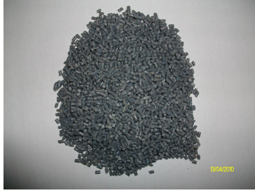
Şekil 6.1. Ekstüruder makinasında üretilen granül formundaki kompozit malzemenin görüntüsü
