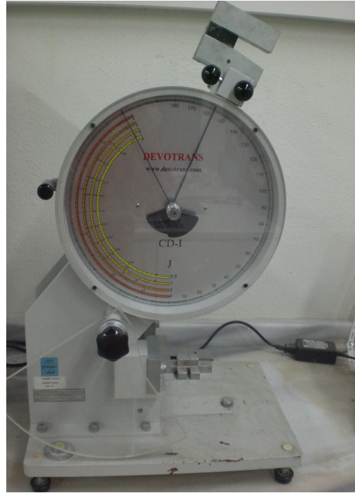
Şekil 6.15. Deneylerde kullanılan Devotrans marka darbe cihazı
