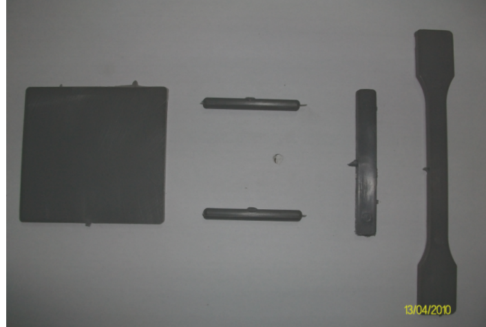
Şekil 6.3. Enjeksiyon kalıbında üretilen çekme, darbe, aşınma ve renk plakalarının görüntüsü
