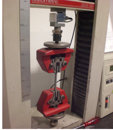
Şekil 6.8. Çekme cihazı çenelerine deney numunelerinin bağlantısının gösterimi
