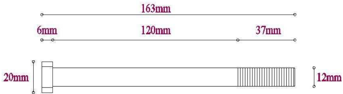
Şekil 3.35. DN5 ve DN6 'da kullanılacak bulon görünümü
