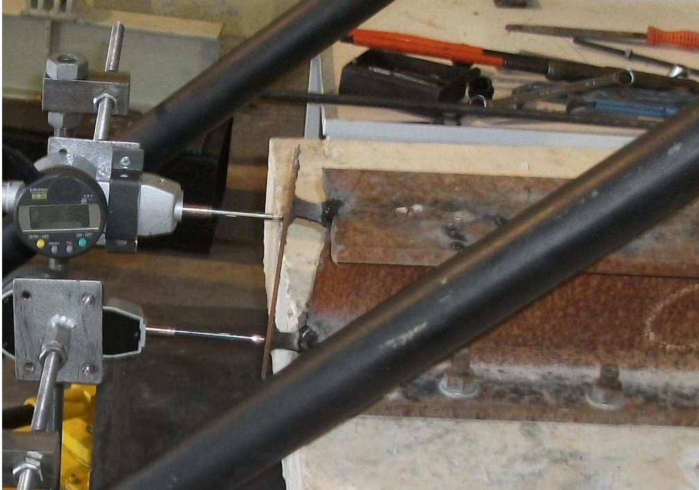
Şekil 3.9 Üst ve alt başlık yatay hareketlerini incelemek için kaynatılan levhanın görünümü
