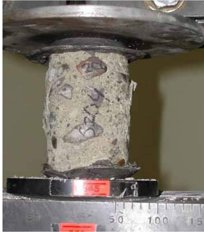
Resim 2.16 Pres altındaki karot
