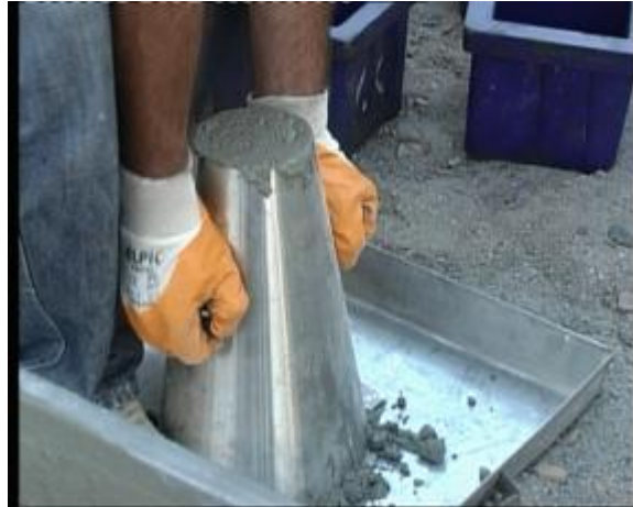
Resim 2.2 Çökme testi uygulaması
