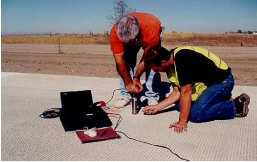
Resim 2.14 Ultrasonik hız metodu
