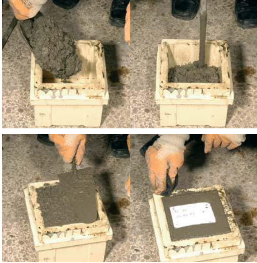
Resim 2.9 Taze Betondan numune alınması
