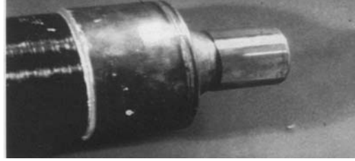
Şekil 2.3. Peugeot yarış arabasının tahrik milinde yapıştırıcı kullanımı [8]
