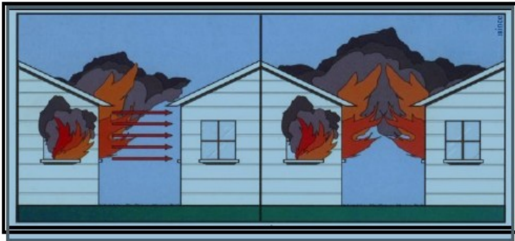
Şekil 2.8. Isının ışıma yolu ile transferi
