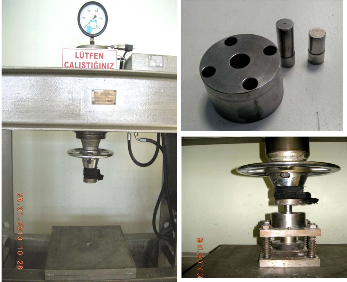
Şekil 4.2. Şekillendirmede kullanılan pres ve kalıp görüntüsü
