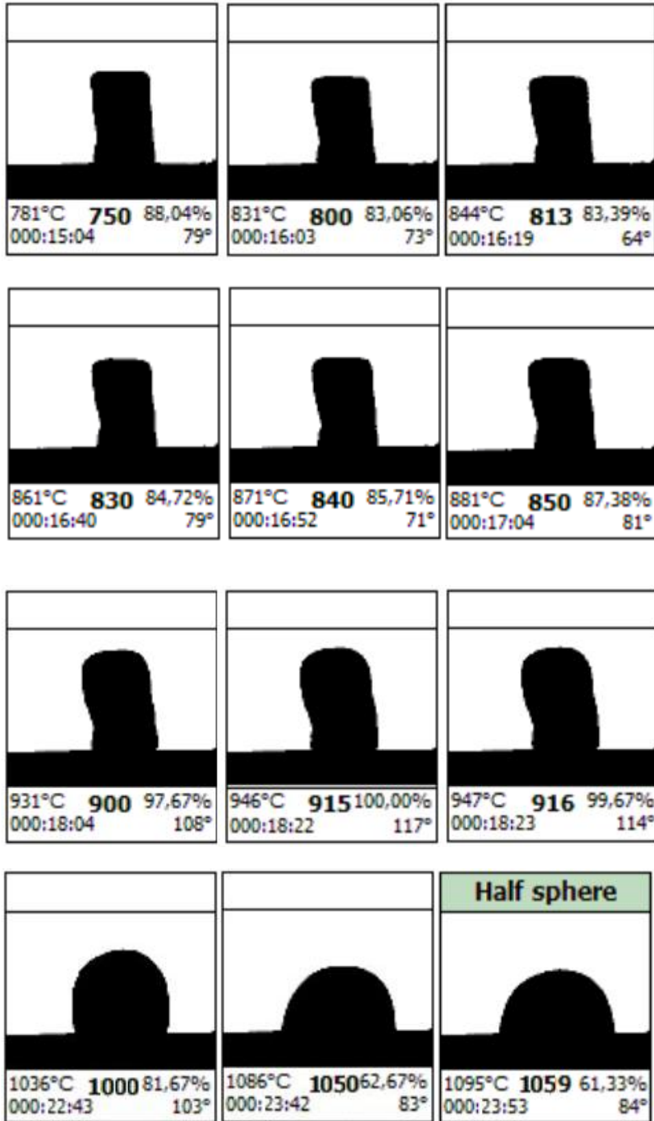
Şekil 5.18. FIG numunesi ısı mikroskop görüntüleri (781 °C – 1095 °C)
