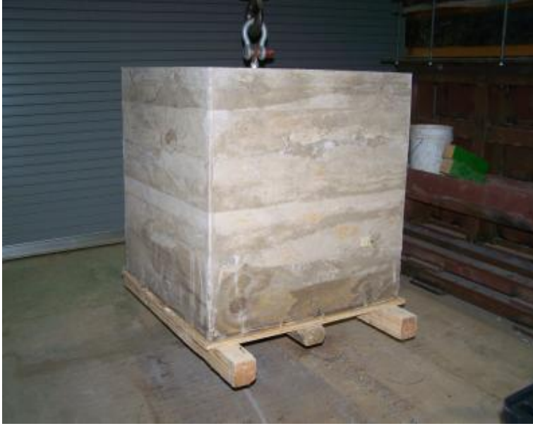
Şekil 2.5. Uçucu kül katkılı beton kalıbı [18]
