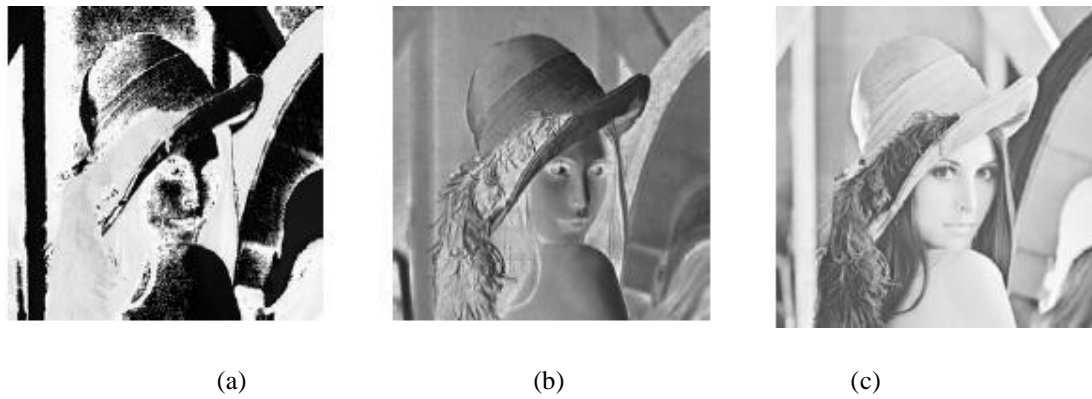
Şekil 2.5. Lena'nın diğer resmi [47] a) H bileşeni (HSV) b) S bileşeni (HSV) c) V bileşeni (HSV)
