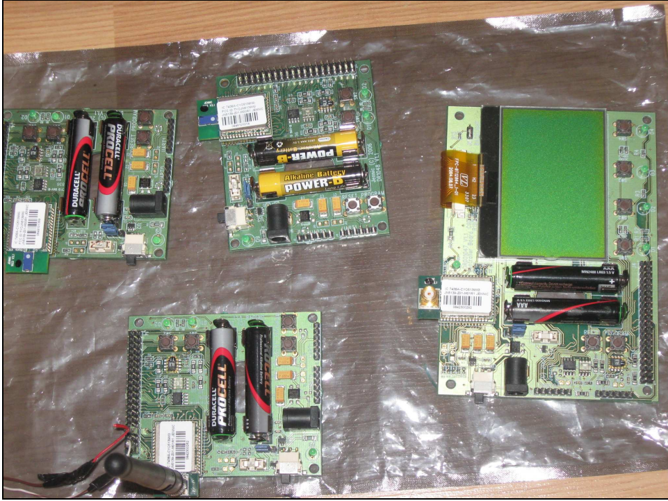
Şekil 3.3. Tez çalışmasında kullanılan kablosuz algılayıcı ağ modülleri
