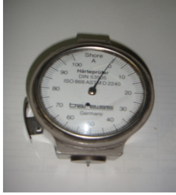
Şekil 5.7. Shore A standardına göre sertlik aleti
