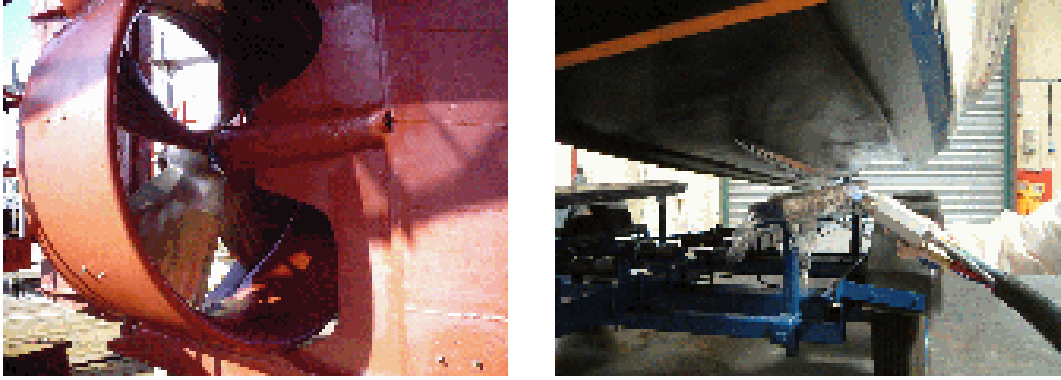
Şekil 3.9. Polimer kaplamaların denizcilik sektöründeki uygulamaları [22]
