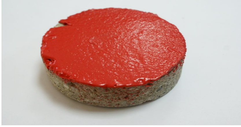
Şekil 6.16. Beton üzerine polimer kaplama
