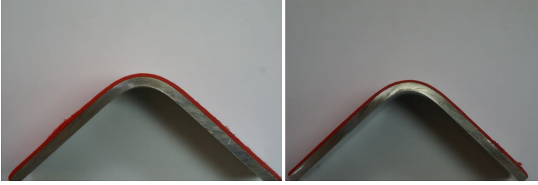
Şekil 6.14. 3 nokta eğme testi sonrasında numunelerin makro görüntüsü
