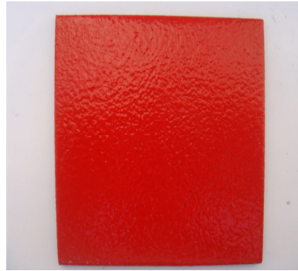
Şekil 5.6. Alev sprej yöntemiyle üretilen polimer kaplamanın makro görüntüsü
