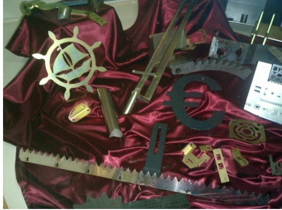
Şekil 4.7. Ermaksan LAZERMAK EL 3004-4 KW lazer kesim tezgahı ile kesilen çeşitli malzemeler
