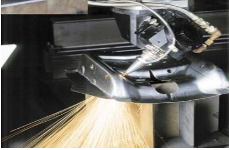
řekil 4.5. Mazak SPGEAR 510-2,5 KW lazer kesim tezgahı ile kesilen form verilmiř para
