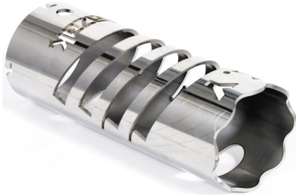
řekil 4.6. Mazak SPGEAR 510-2,5 KW lazer kesim tezgahı ile kesilen paslanmaz boru
