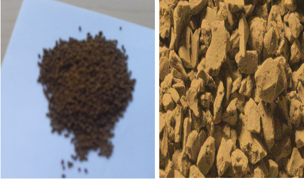
Şekil 3.4. Bayoxide® E33 ferrik oksit medyası
