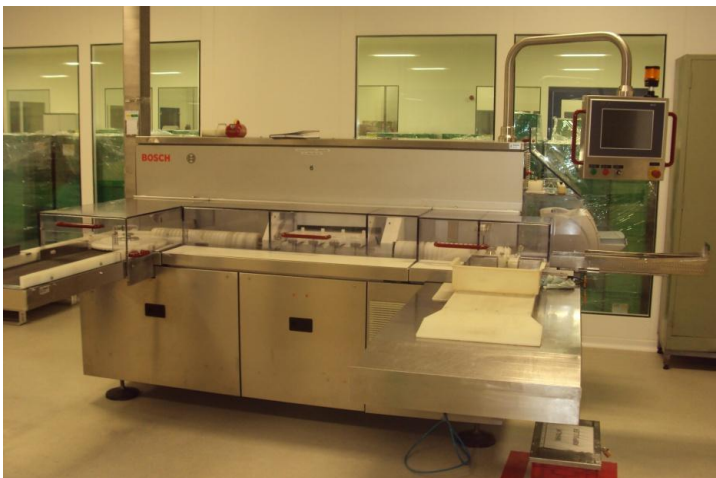
Şekil 5.17. Flakonların çatlaklığını kontrol eden test makinesi
