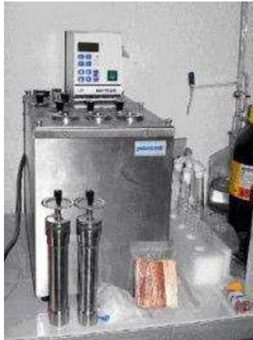
Şekil 3.6. Bakır şerit korozyonu ölçüm cihazı (Petrotest) (www.egebiyoteknoloji.com)
