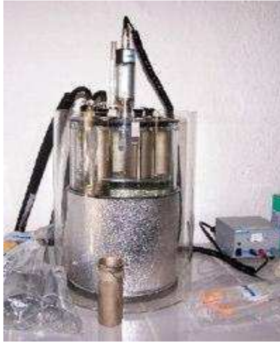
Şekil 3.4. Akma ve Bulutlanma noktası ölçüm cihazı (Petrotest) ( www.egebiyoteknoloji.com )
