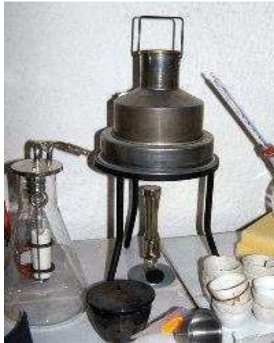
Şekil 3.5. Karbon Kalıntısı Ölçüm Cihazı (Petrotest) (www.egebiyoteknoloji.com)
