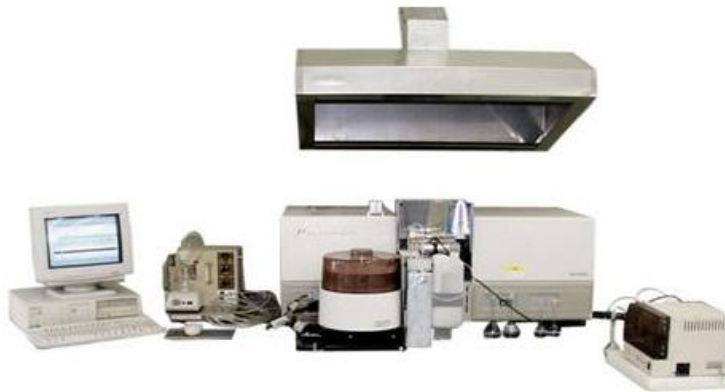
Şekil 3.1. Alevli atomik absorpsiyon spektrometre (FAAS) cihazının genel görünümü
