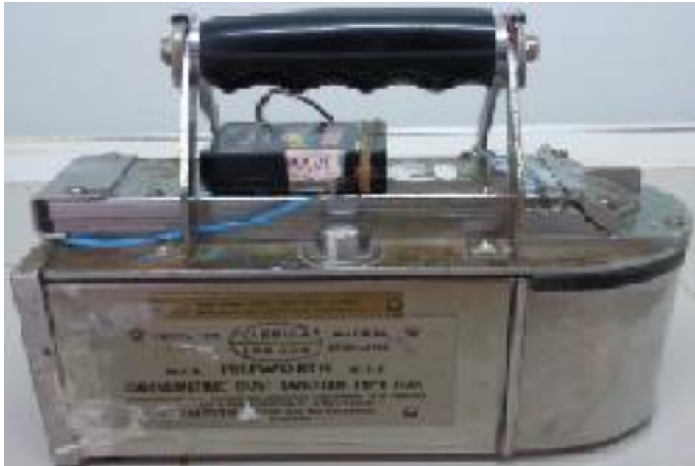
Şekil 3.4. Isleworth Gravimetric Type 113A hava toz örnekleyicisi
