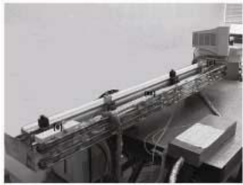
Şekil 3.13. Uydularda kullanılan ısı borularının test düzeneği (a) evaporatör, (b) adyabatik kısım, (c) kondensatör
