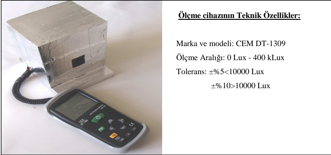
Şekil 5.8. Işık şiddeti ölçme cihazı (Lüksmetre) resmi ve teknik özellikleri
