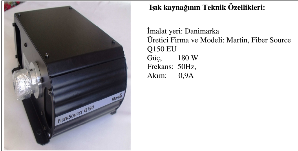
Şekil 5.7 Fiber optik kablo ışık şiddetinin ölçülmesi için kullanılan ışık kaynağının resmi ve teknik özellikleri
