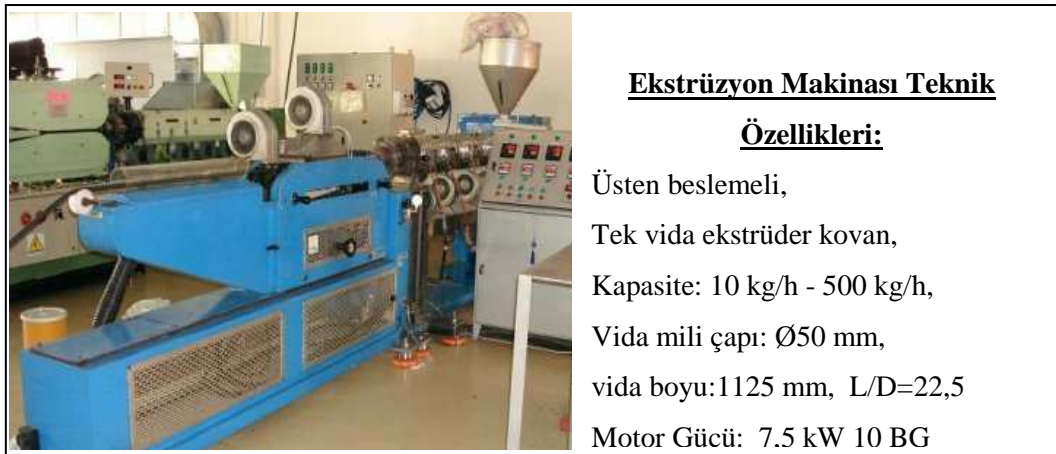
Şekil 5.1 Ekstrüzyon makinesinin resmi ve teknik özellikleri
