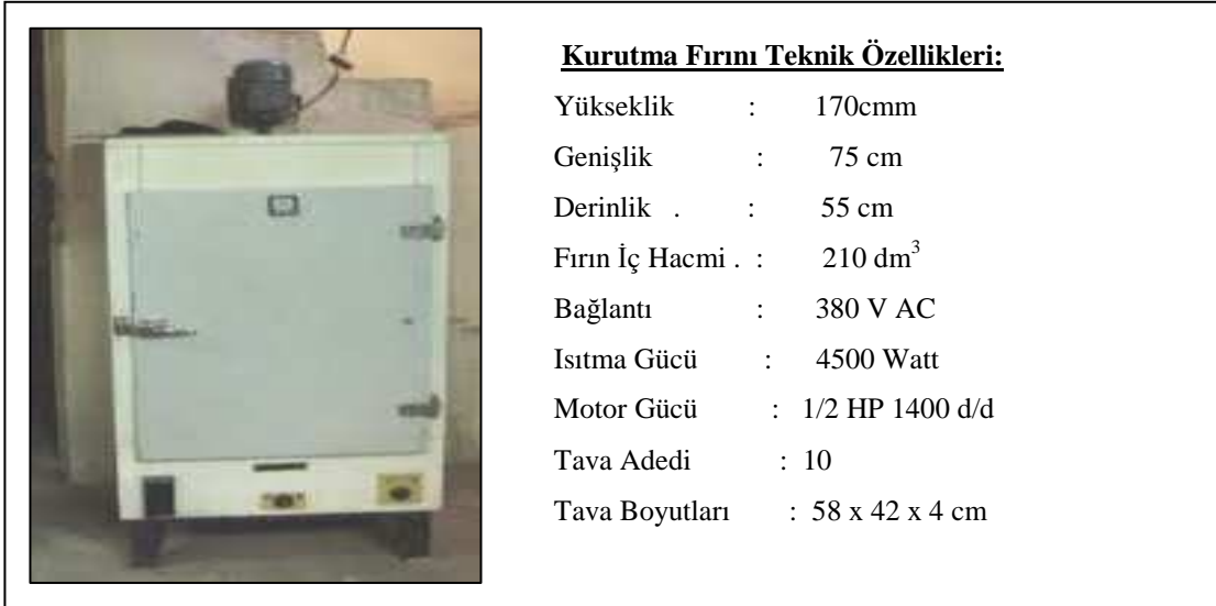
Şekil 5.6. Plastik kurutma fırını resmi ve teknik özellikleri
