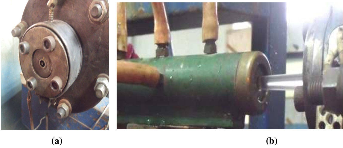
Şekil 5.4. a ) Ekstrüzyon kalıbının makineye montaj görünümü b ) Ekstrüzyon kalıbından ürünün çıkışı ve kalibre edilmesi
