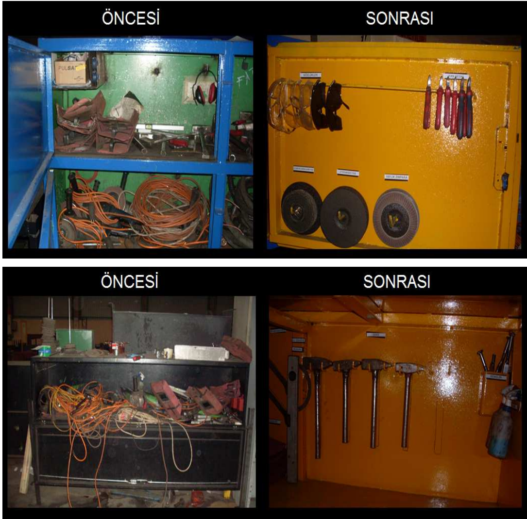
Şekil 4.30b. 5S öncesi ve sonrası görüntüleri
