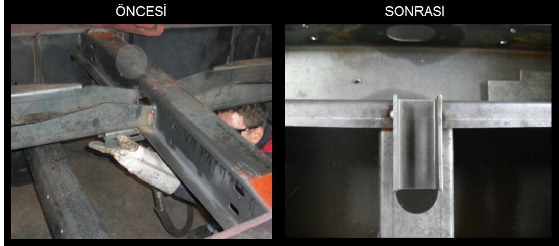
Şekil 4.24. Karkas U bağlantı parçası puntalama operasyonu
