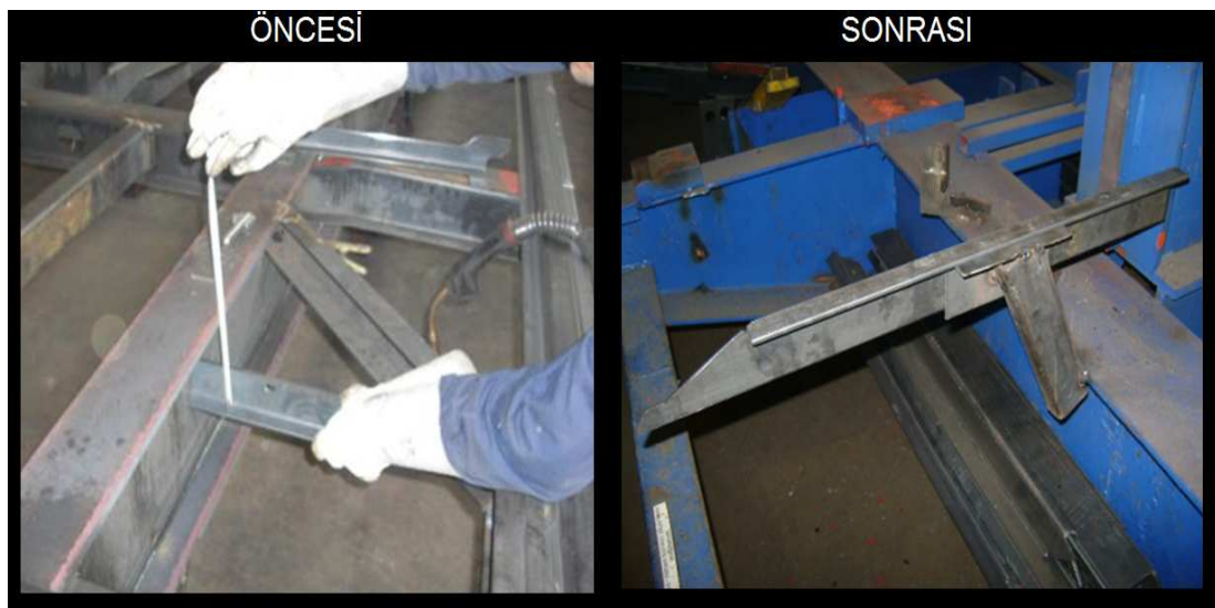
Şekil 4.21. Sürgülü merdiven bağlantı köşebenti puntalama operasyonu
