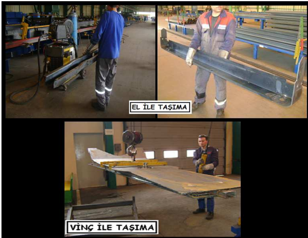
Şekil 4.41. Hazırlık istasyonları taşıma uygunsuzlukları
