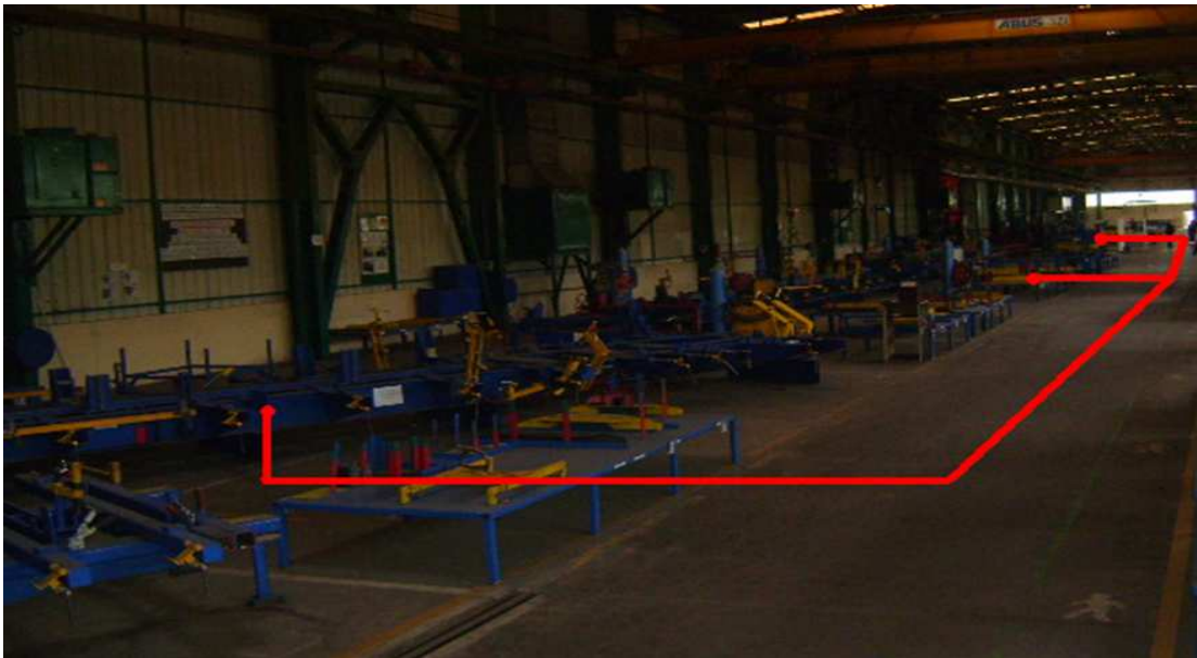
Şekil 4.37. Puntalama sonrası araçların vinç ile taşıma mesafesi
