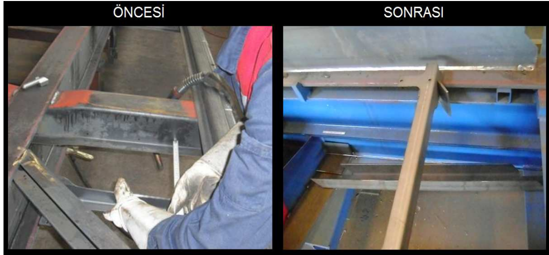
Şekil 4.20. Kapı kolu tutacağı bağlantı köşebenti puntalama operasyonu
