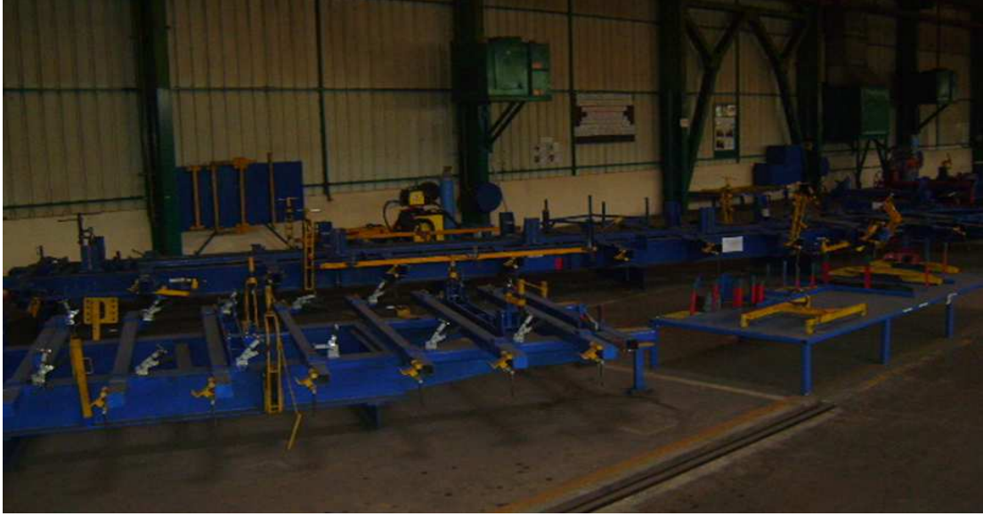
Şekil 4.36. Çapraz konumlu fikstür yerleşiminin getirdiği çalışma zorlukları
