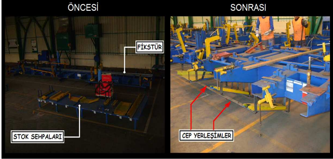
Şekil 4.38. Fikstürlere yapılan cep yerleşimler
