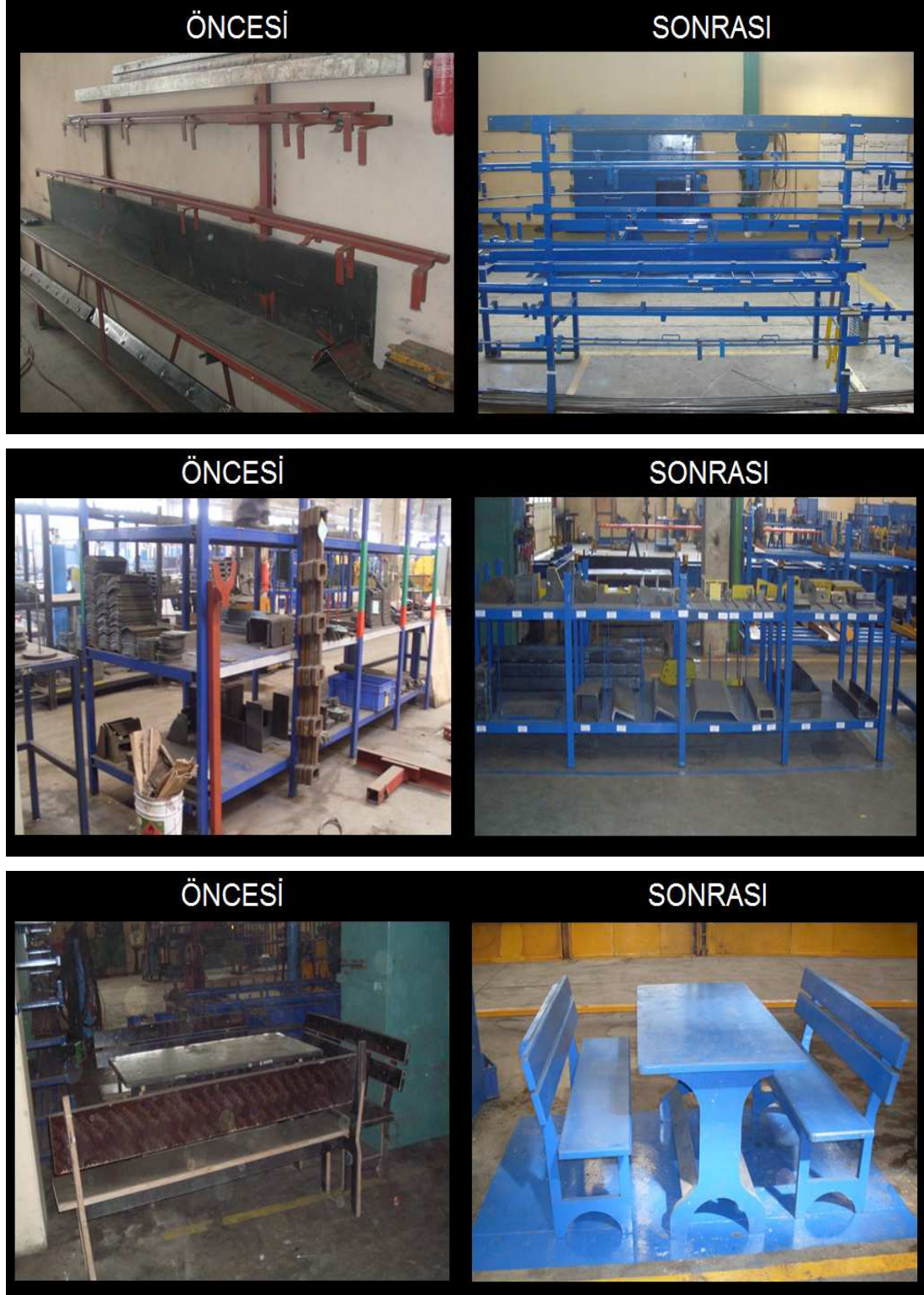
Şekil 4.30a. 5S öncesi ve sonrası görüntüleri
