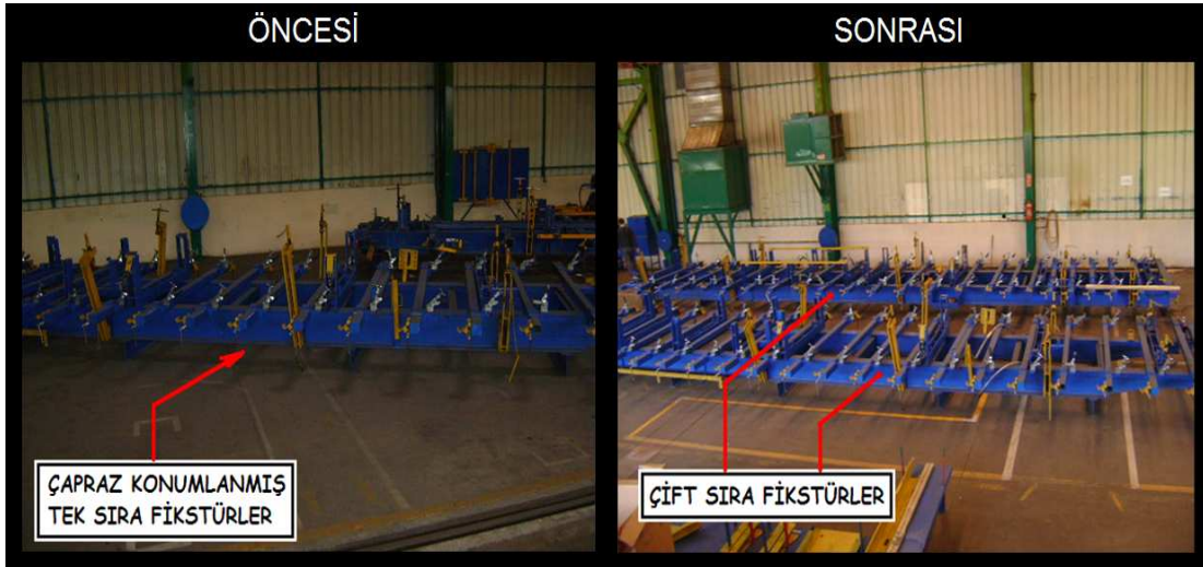
Şekil 4.39. Çift sıra yerleştirilen fikstürler
