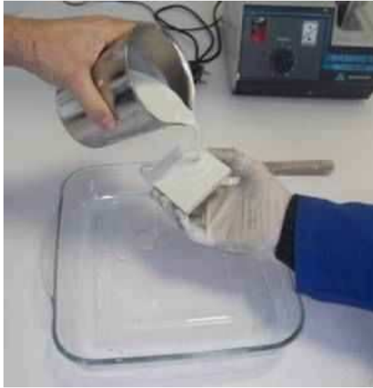
Fotoğraf 10. Numunelerin akıtma yöntemiyle astarlanması
