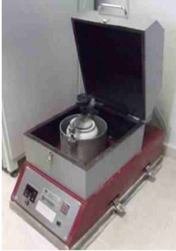
Fotoğraf 14. Nano boyutlu pigment elde etmek için jet değirmende öğütme
