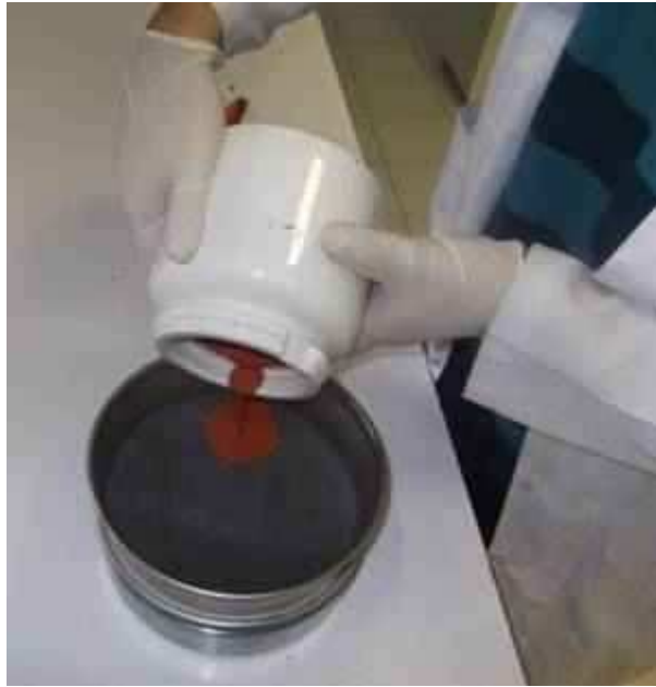
Fotoğraf 15. Değirmen sonrası boyaların 250 \mu\text{m} elekten geçirilmesi
