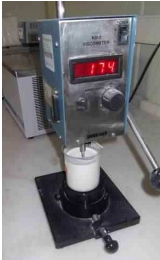
Fotoğraf 8. Astarın viskozite ölçüm cihazı
