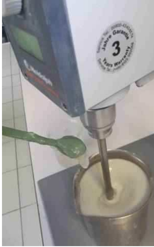
Fotoğraf 3. amur hazırlama sırasında selüloz eklenmesi
