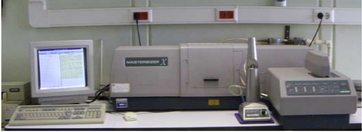
Şekil 5.2. MALVERN mastersizer-X tane boyut analiz cihazı
