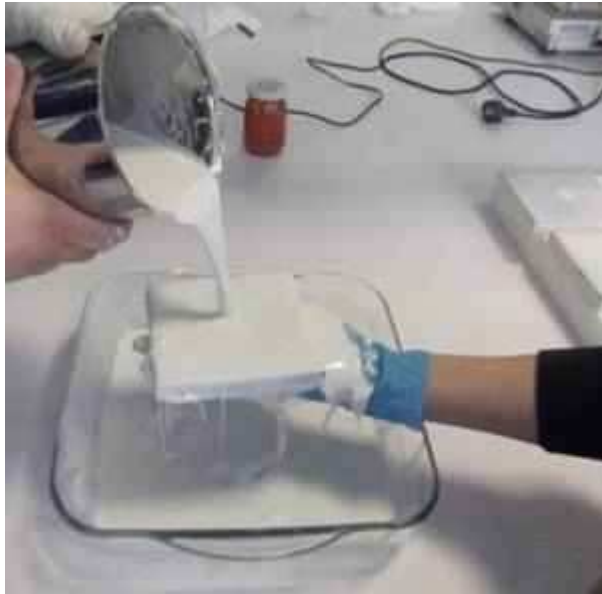
Fotoğraf 17. Akıtma yöntemiyle sır uygulaması
