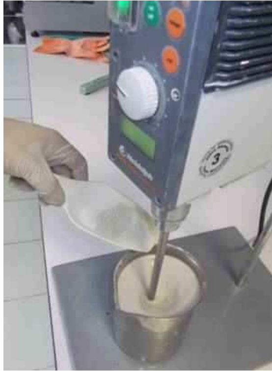
Fotoğraf 1. Çamur hazırlama toz halde hammadde eklenmesi
