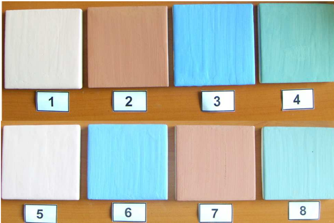
Şekil 6.97. Boyanmış -sırlanmamış numunelerin fotoğrafları (1-2-3-4 numaralı numuneler geleneksel boya ile, 5-6-7-8 numaralı numuneler nano boya ile boyanmıştır.)
