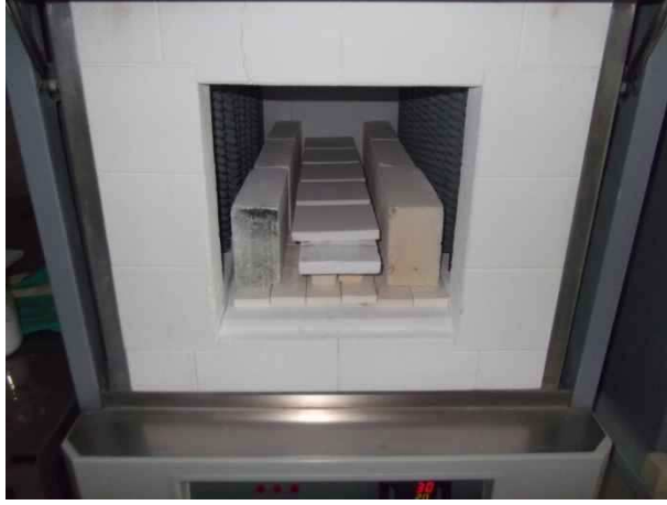
Fotoğraf 20. Nihai (sırlı) pişirim öncesi numunelerin fırına dizilmesi
