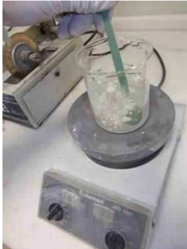
Fotoğraf 1. Çamur hazırlama toz halde hammadde eklenmesi
