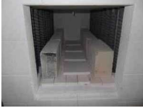
Fotoğraf 12. Etüvde kurutulan numunelerin bisküvi pişirimi için fırına dizilmesi
