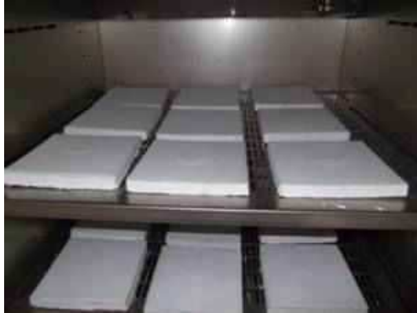
Fotoğraf 19. Sırlama sonrası numunelerin etüvde kurutulması
