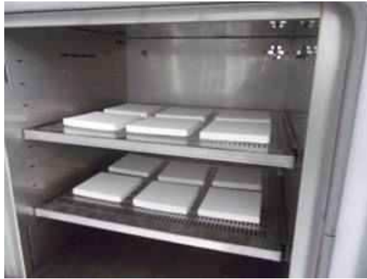
Fotoğraf 11. Astarlanan numunelerin etüvde 80°C'de ~2 saat, 110°C'de ~22 saat kurutulması
