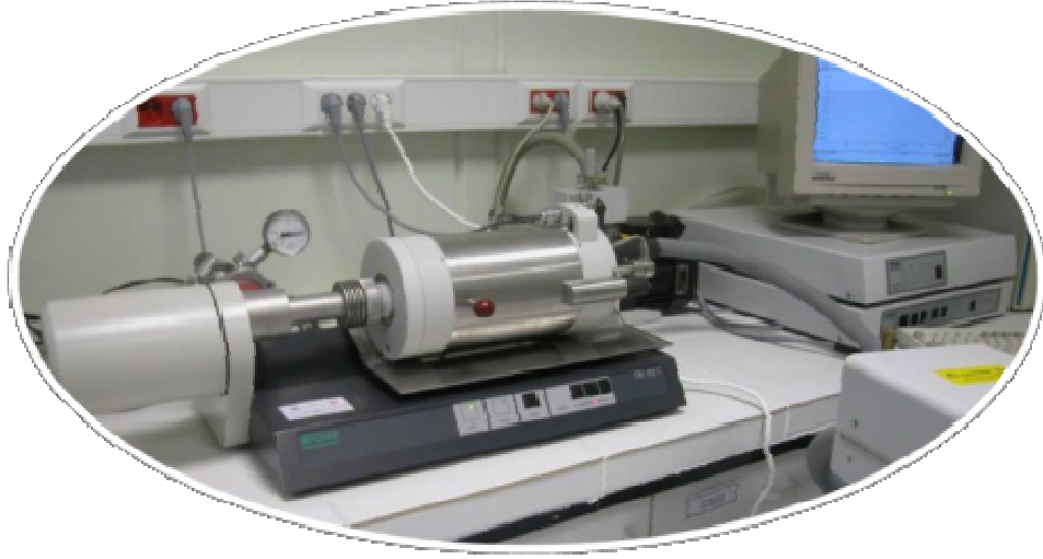
Şekil 5.13. NETZSCH marka DIL 402 C model dilatometre cihazı
