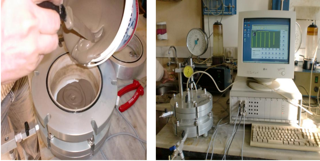
Fotoğraf 5.15. Rowe hücresine numune yerleştirme ve deney düzeneği
