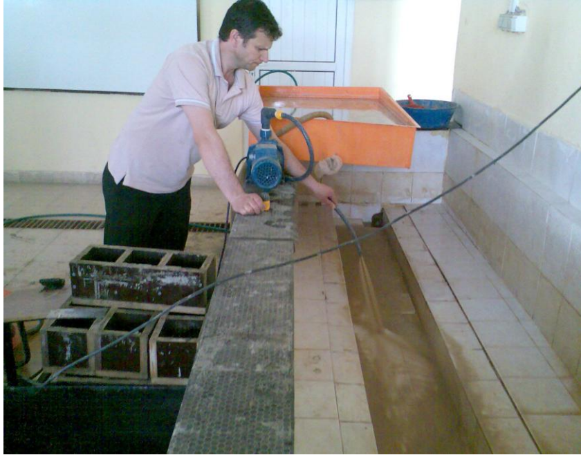
Fotoğraf 5.5. Santrifüjle kilin büyük havuza pompalanması
