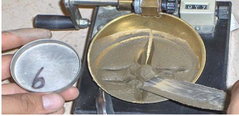
Fotoğraf 5.11. arpmalı alette (Casagrande) likit limit deneyi
