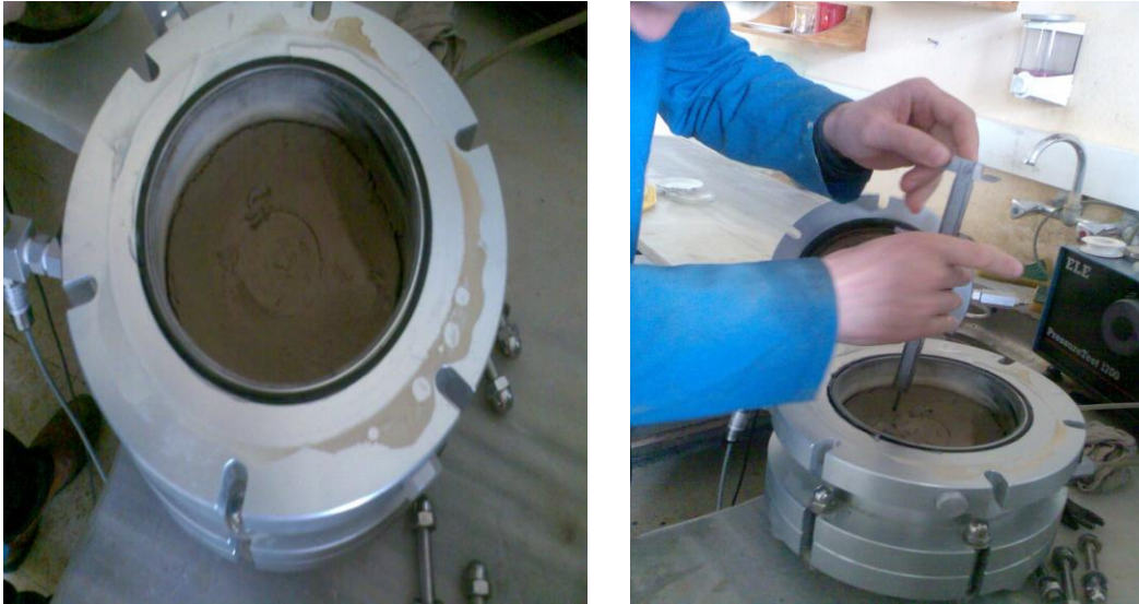
Fotoğraf 5.16. Rowe hücresi deney sonu numune boyu ölçme
