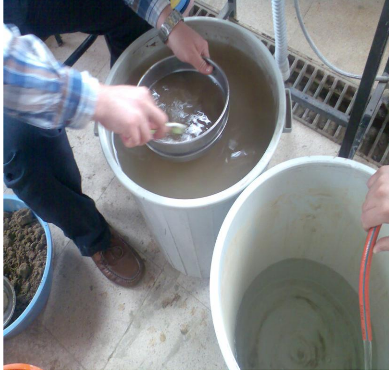
Foto 5.6. Silt-kum karışımından siltin yıkama eleme yöntemiyle elde edilmesi
