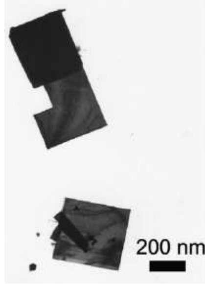
Şekil 4.13. Prusya mavisi nano yapraklarının TEM görüntüsü [58]
