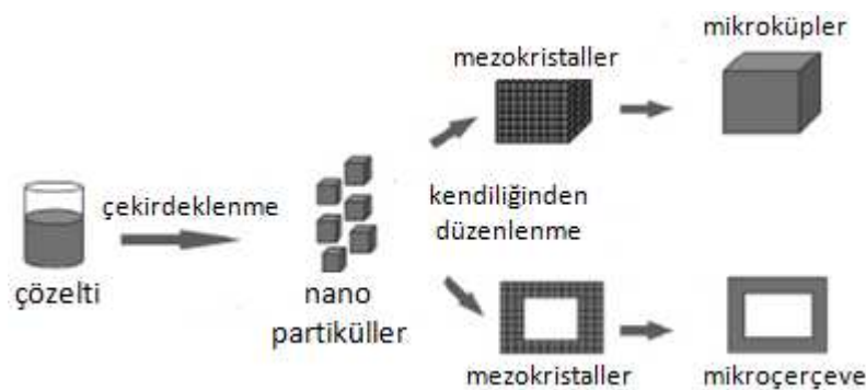
Şekil 4.10. Prusya mavisi partiküllerinin büyüme mekanizması [57]
