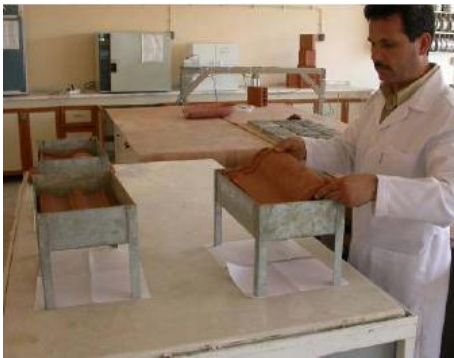
Şekil 3.13. Kiremitte su emme deneyi
