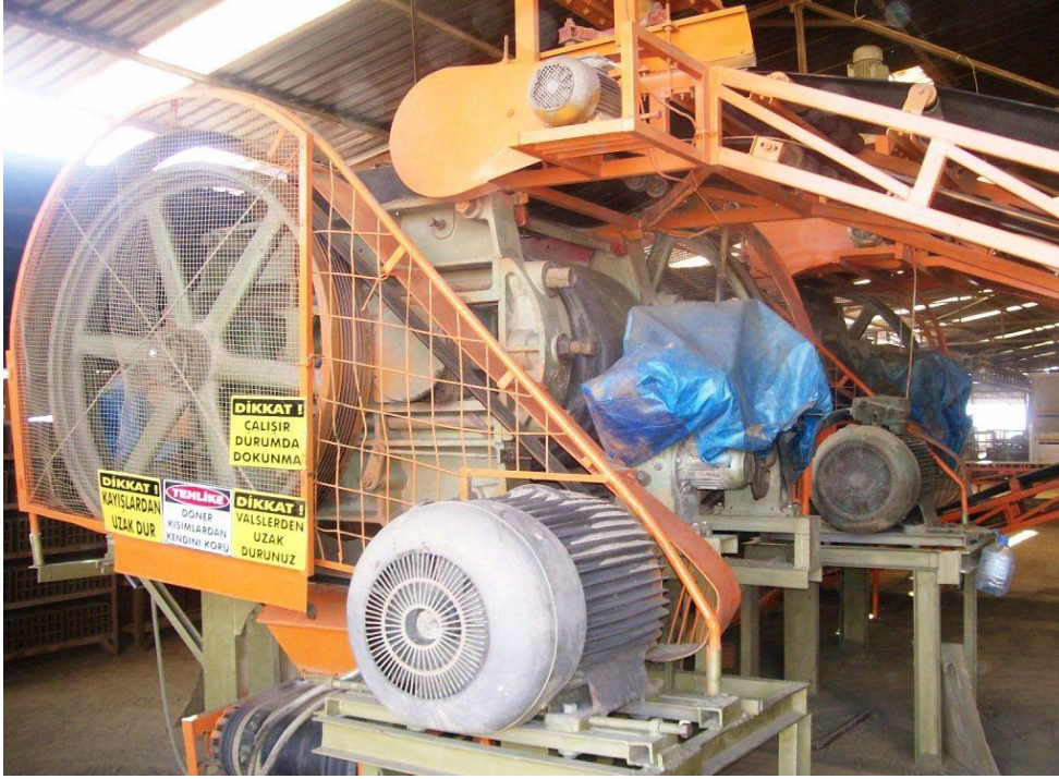
Şekil 3.3. Öğütülerek hammaddenin istenilen boyuta düşürülmesi
