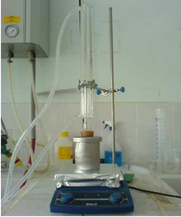
Şekil 5.6. Isıtıcı karıştırıcı, liç kabı ve geri soğutucudan oluşan liç ünitesi
