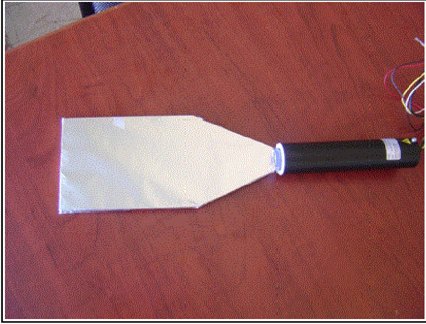
Şekil 3.5.Sintilatör paletinin alüminyum folyo ile kaplanmış hali
