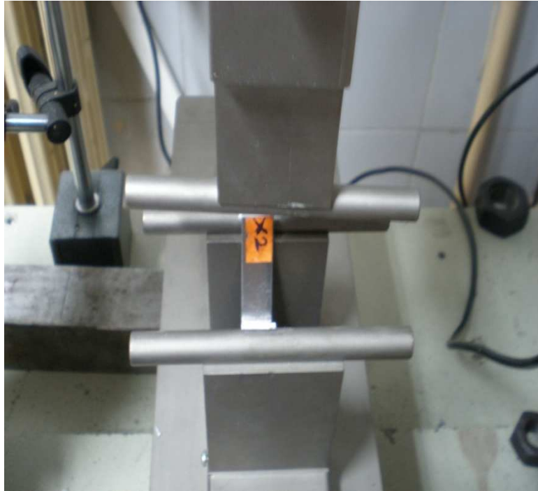
Şekil 4.6. Eğme deneyi cihazı ve uygulama görüntüsü
