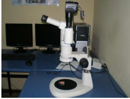
Şekil 4.8. Makroyapı incelemelerinde kullanılan Nikon marka L 150 A model optik stereoskop
