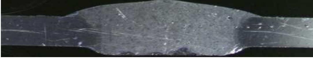
Şekil 5.50. Sertlik alınan bölgelerin gösterimi (her bir numune için aynı bölgelerden sertlik değeri alınmıştır)
