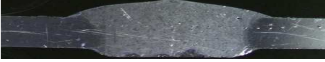
Şekil 5.46. Sertlik alınan bölgelerin gösterimi ( her bir numune için aynı bölgelerden sertlik değeri alınmıştır. )
