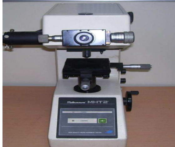
Şekil 4.9. Mikrosertlik ölçümlerinde kullanılan Matsuzawa MHT-2 model cihaz
