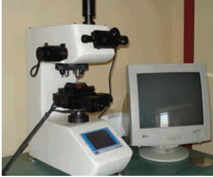
Şekil 5. 22. Future-tech corp. FM-700 mikrosertlik ölçme cihazı
