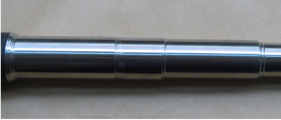
Şekil 6. 100. Sertleştirilmiş AISI 4140 çeliğinin \beta -SiAlON kesici takımlarıyla işlenmesi sonucu elde edilen yüzey
