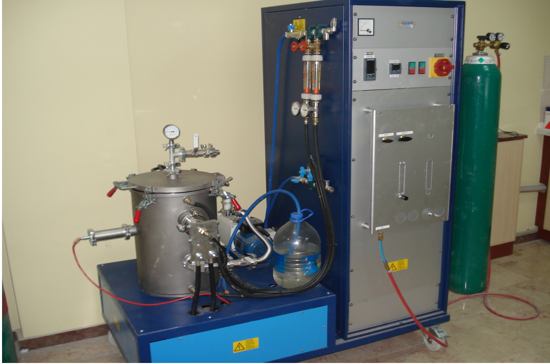
Şekil 5. 15. Yüksek sıcaklık grafit fırını
