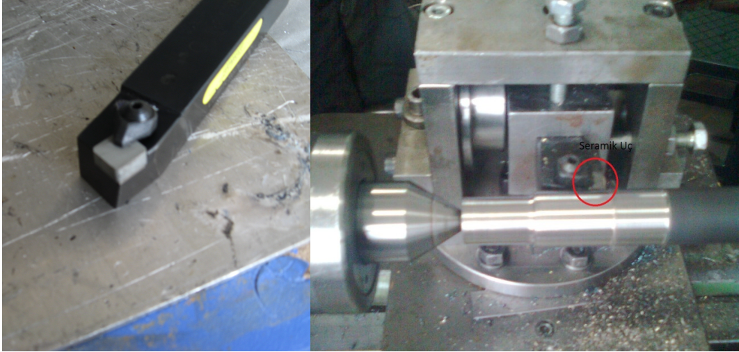
Şekil 6. 87. AISI 4140 çeliğini Seramik kesici uç ile işlenmesi
