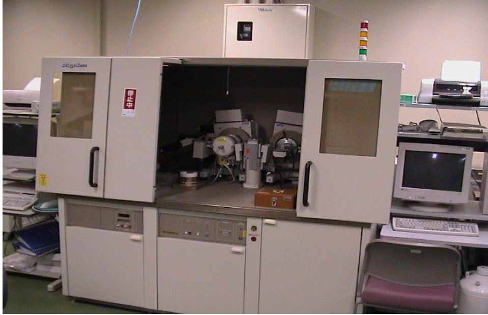
Şekil 5. 17. XRD cihazının genel görünümü
