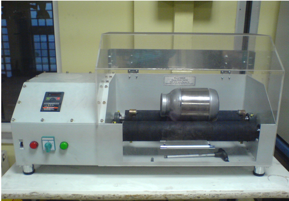
Şekil 5. 8. Toz hazırlamada kullanılan bilyalı değirmen cihazı ve \text{Si}_3\text{N}_4 bilyalar
