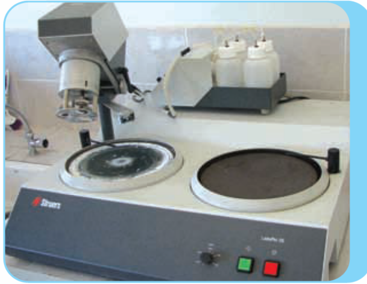
Şekil 5. 18. Struers Labopol-25 parlatma ve zımparalama cihazı
