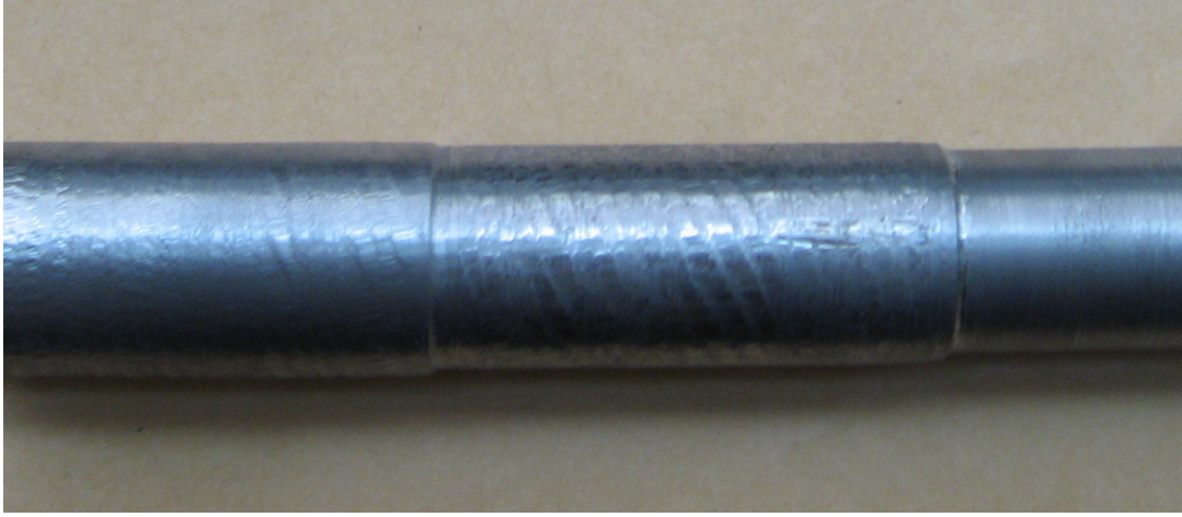
Şekil 6. 99. Sertleştirilmiş AISI 4140 çeliğinin WC kesici takımlarıyla işlenmesi sonucu elde edilen yüzey pürüzlülüğü
