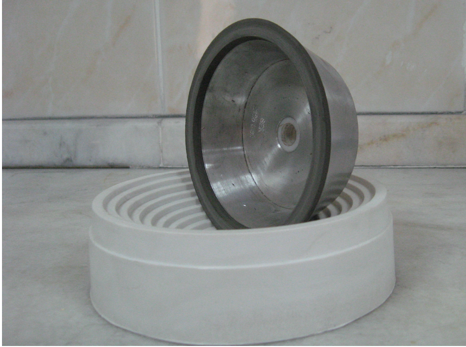
Şekil 5. 34. Seramik kesici takım taşlamak için kullanılan elmas taşlama diski
