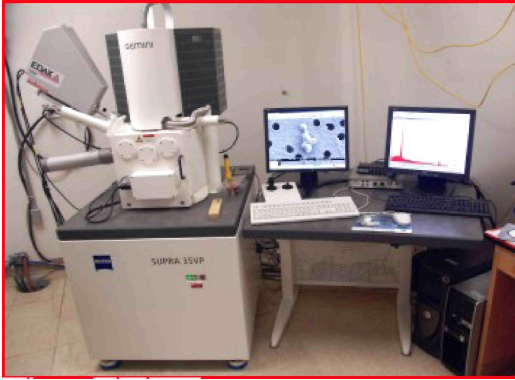
Şekil 5. 20. SEM cihazının genel görünümü
