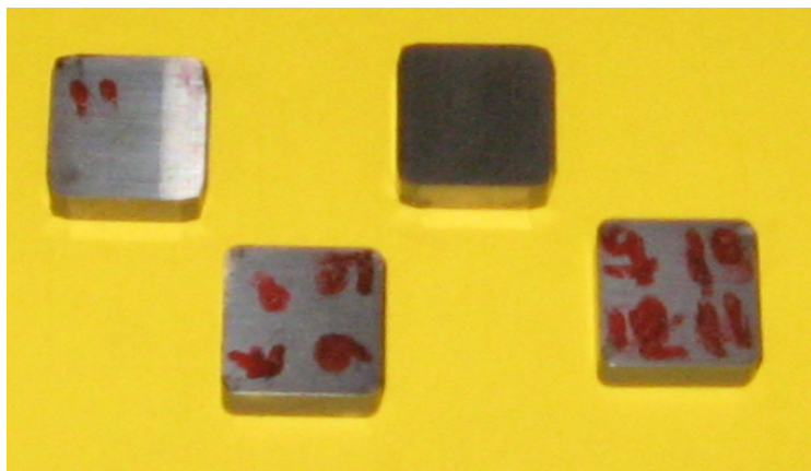
Şekil 6. 98. Tizit Marka WC kesici takımları
