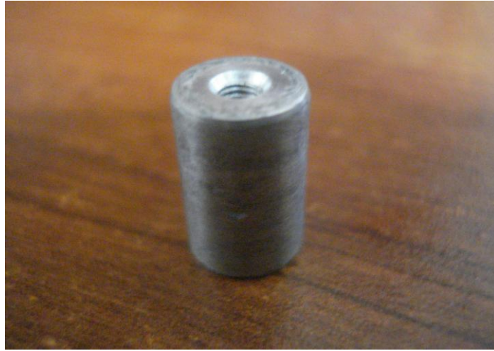
Şekil 4.9. Üretilen korozyon deneyi numunesi
