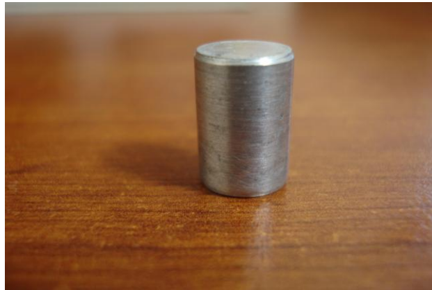
Şekil 4.5. Üretilen basma deneyi numunesi
