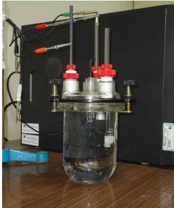
Şekil 4.7. Korozyon deney hücresi
