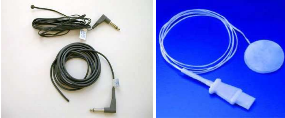
Şekil 3.2. Çeşitli sıcaklık sensörleri
