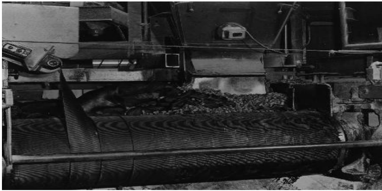
Şekil 5.2. Bir Silindir karıştırıcı
