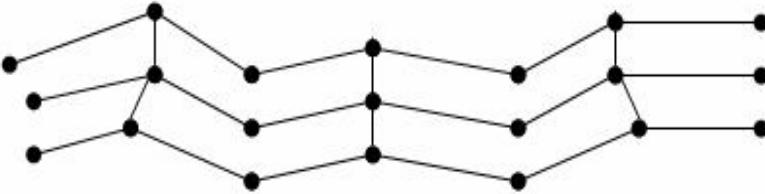
Şekil 1.2. Termoset plastik polimer zinciri
