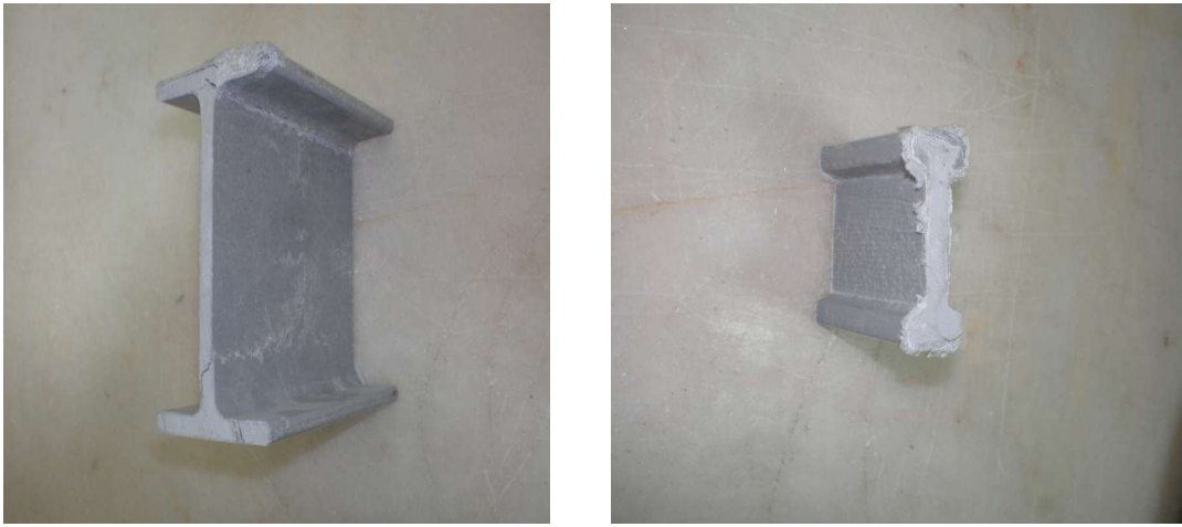
Şekil 4.40. I kesitli profillerde deney sonrası oluşan kırılma ve ezilmeler
