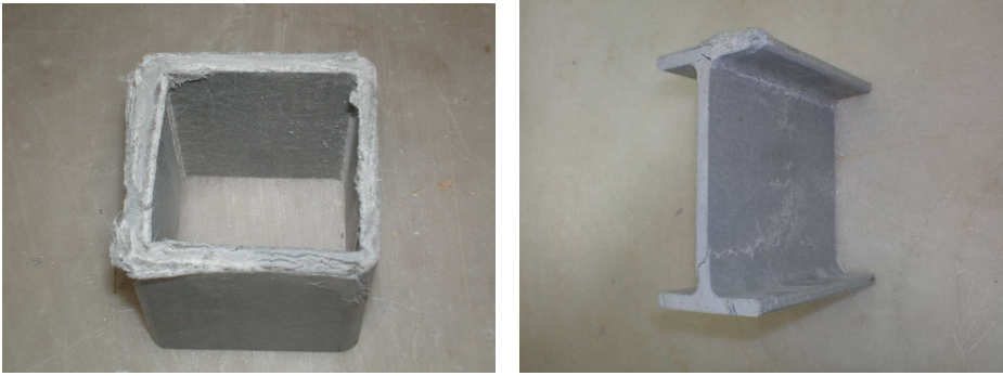
Şekil 4.36. Basınç deneyi sonrası numunelerde oluşan deformasyonlar
