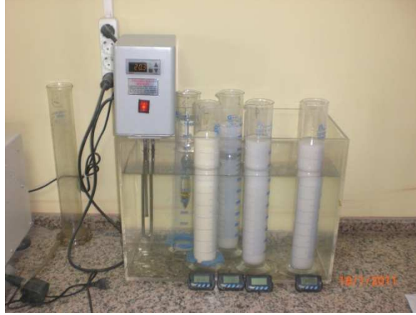
Şekil 5.5. Hidrometre Deneyi Yapım Aşaması
