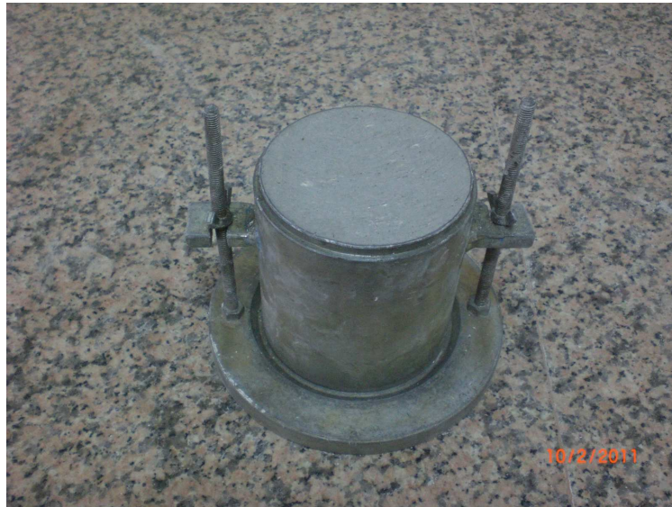
Şekil 5.14. Sıkıştırma işlemi tamamlanmış zemin numunesi
