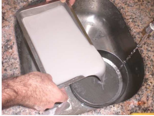
Şekil 5.4. Yıkamalı Elek Analizi Yapım Aşaması
