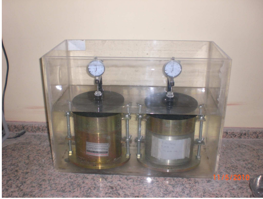
Şekil 5.19. Numunenin suda bekletilmesi
