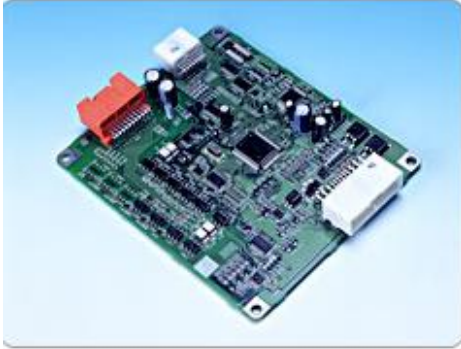
Şekil 4.40. Batarya kontrol ünitesi [48]
