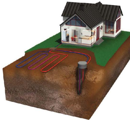
Şekil 1.1. Yatay ve dikey toprak ısı değiştiricileri
