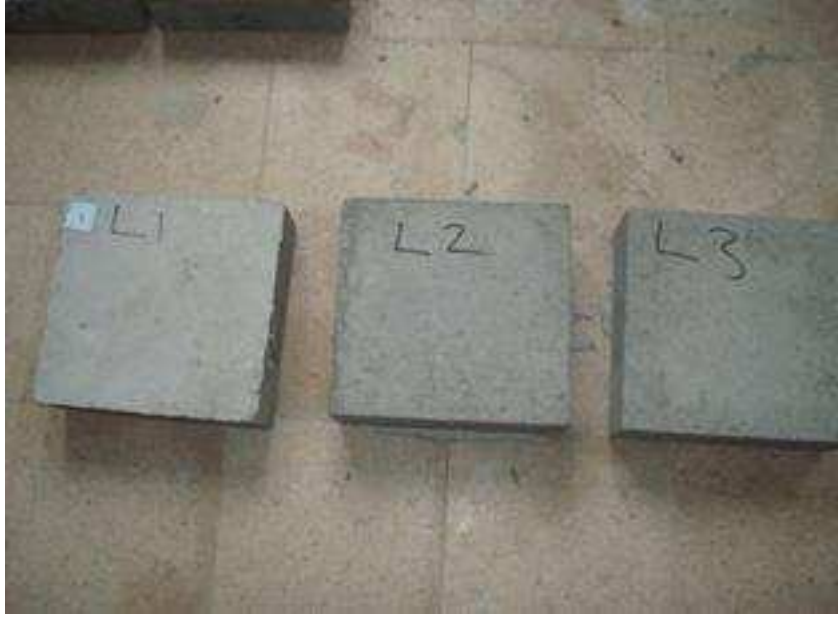
Şekil 6.3. 30x30x10 cm'lik plak numuneleri
