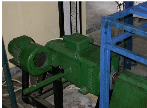
Şekil 4.2. Deneylerde kullanılan dinamometrenin görünüşü [53]
