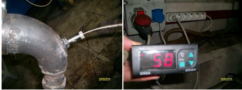
Şekil 4.5. Egzoz sıcaklıklarını ölçmede kullanılan cihaz
