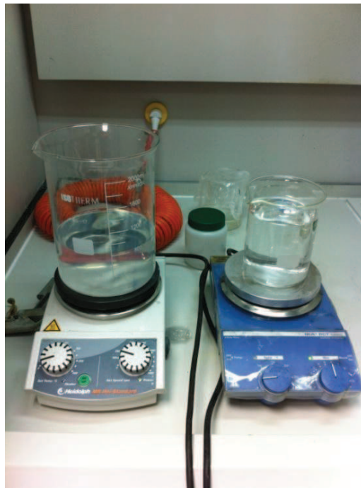
Şekil 11 \text{Ca}(\text{NO}_3)_2 \cdot 4\text{H}_2\text{O} veya \text{Ca}(\text{OH})_2 ve \text{H}_3\text{PO}_4 'in manyetik karıştırıcıda karıştırılması
