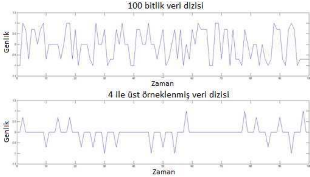
Şekil 3.8. 100 bitlik veri ve üst örneklenmiş halinin karşılaştırması
